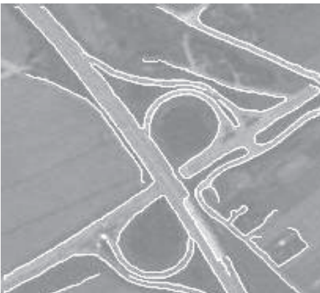
Abb. 8(b): Kantendetektion mit Luftbild (Originaldaten: 330 × 325 Pixel).
