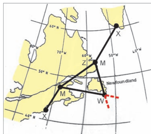
Abb. 8: Die beiden Loran-C Netze im Bereich Neufundland sowie der rot markierte Bereich der Baseline Extension.
