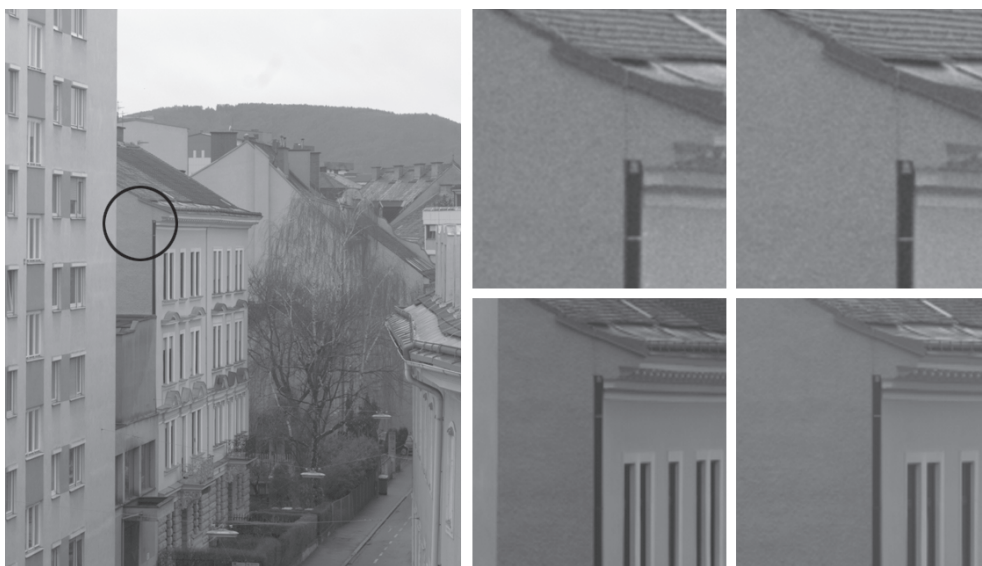
Abb. 3: Korrelationsergebnisse an einer schwach strukturierten Gebäudefassade (links) zeigen deutlich die Überlegenheit der digitalen Aufnahme. Das Filmbildpaar (Rolleimetric 6006, c = 150 mm, AGFA APX) wurde mit 20\ \mu\text{m} Pixelgröße (GSD = 1 cm) abgetastet, das digitale Bildpaar mit c = 48 mm und einer Pixelgröße von 1,7 cm (GSD) aufgenommen. Die Streuungen bei den Horizontalparallaxen bei 100 Messpunkten betragen etwa 1/3 Pixel oder \pm 3 mm beim analogen und 1/10 Pixel oder \pm 1,7 mm beim digitalen Beispiel (rechts unten).
