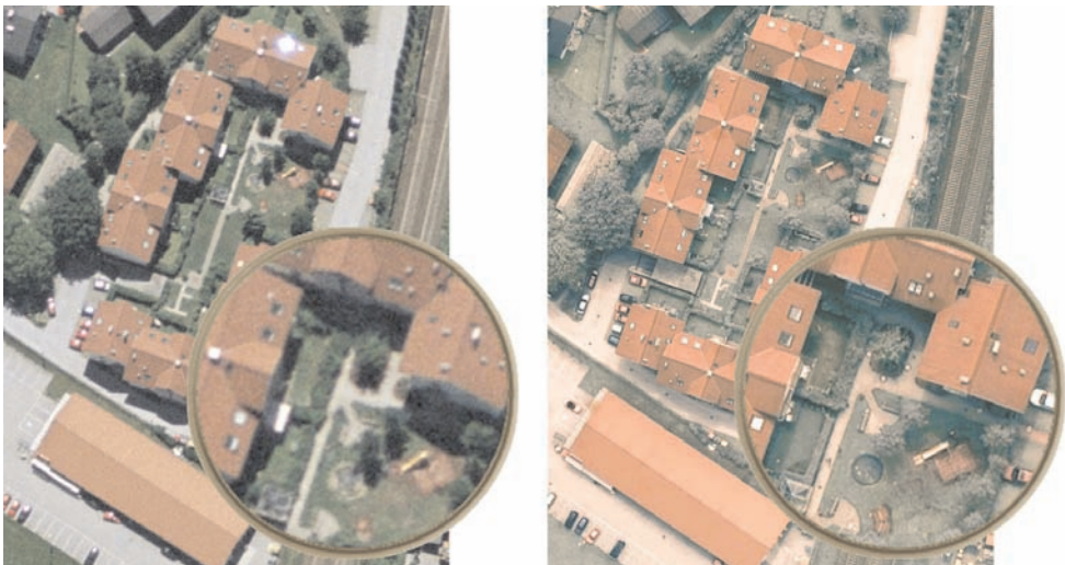
Abb. 2: Analoge und digitale Luftbildaufnahmen im direkten Vergleich. Die analoge Aufnahme vom 6. Juli 2002 auf AGFA X 100 Farbnegativfilm zeigt wesentlich weniger Details als die digitale Aufnahme vom 9. August 2002. Die Detailvergrößerung zeigt in beiden Fällen einen Bildkreis mit einem Durchmesser von 210 Pixel oder 31 Meter in 2-facher Vergrößerung.
