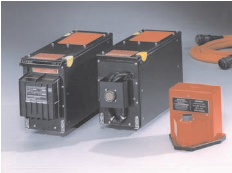
Abb. 14: Das erste AEROcontrol-II System, basierend auf dem Litef LCR-88 Sensor mit dry-tuned Gyros.
