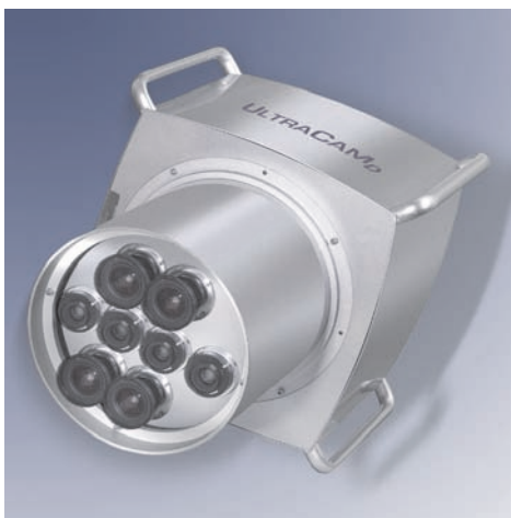
Abb. 7: Ansicht der Sensoreinheit von unten. Im Sensor befinden sich 8 Objektive, davon dienen 4 für die panchromatische Aufnahme, 4 für die Aufnahme der 4 Farbkanäle rot, grün, blau und infrarot. Jedes Objektiv hat dasselbe Gesichtsfeld. In der Bildebene sind die Flächenarrays angebracht. Der panchromatische Konus mit 4 CCDs dient als „Masterkonus“ zur Festlegung des Bildkoordinatensystems.
