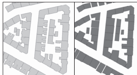
Abb. 4: Gebäudevereinfachung: Ausgangssituation (links), vereinfachte Gebäudegrundrisse (rechts).
