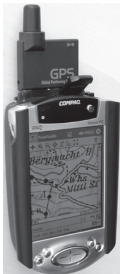
Abb. 4: TourGuide bestehend aus Pocket PC, GPS-Karte und GPRS-Modemkarte.
