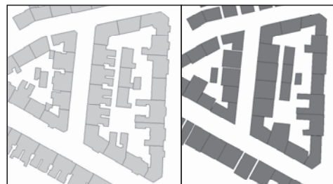
Abb. 4: Gebäudevereinfachung: Ausgangssituation (links), vereinfachte Gebäudegrundrisse (rechts).
