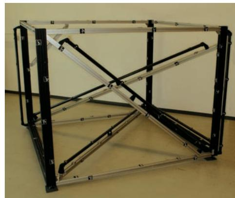
**Abb. 2:** Messaufbau zur Ermittlung der Längenmessunsicherheit (AICON).
