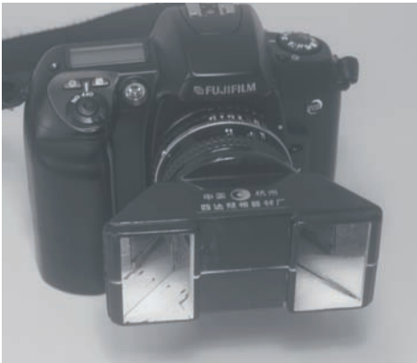
Abb. 1: Digitalkamera Fuji FinePix S1 Pro mit Stereostrahlteiler Stereoworld.
