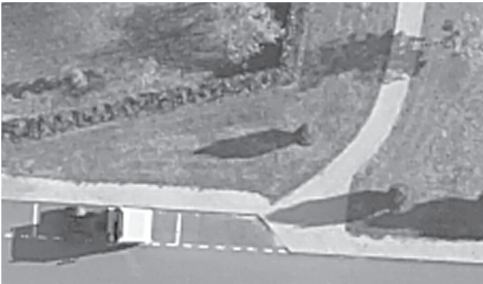
Abb. 11: Effekte der Kantenverstärkung bei Aufnahmen mit der Rolleiflex; man beachte den dunklen Rand der Schatten und den anschließenden hellen Streifen, Größe des Bildausschnitts 229 \times 134 Pixel.
