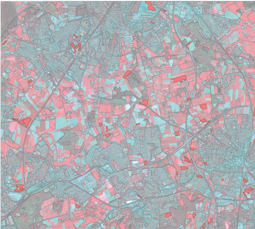
Abb. 4: Binäre Change-Maske (rot umrandet = verändert) überlagert mit dem Differenz-Bild und der ursprünglichen DeCOVER-t0-Kartierung (graue Linien).
