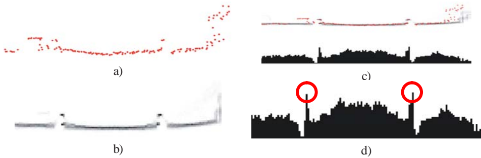
Abb. 3: a) Punkte eines Querprofils über einem Gleiskörper. b) Summenbild über mehrere (hier 77) Querprofile mit 2,5 cm Raster. c) Überlagerung des Querprofils mit seinem Summenbild. d) Summenbild als Histogramm; Gleisköpfe sind mit einem Kreis markiert.
