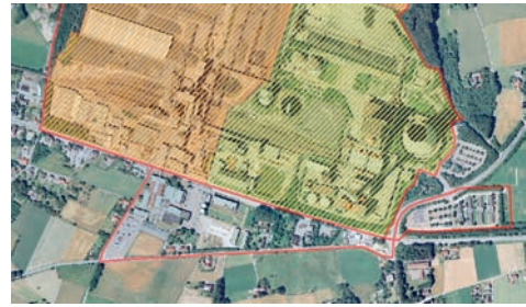
Abb. 3: Überlagerungsfläche im Basis-DLM, Beispiel I Industriegebiet: 2112 Industrie- und Gewerbefläche (rot umrandet) über 2126 Kraftwerk (gelb schraffiert) und 2301 Tagebau (orange schraffiert).
