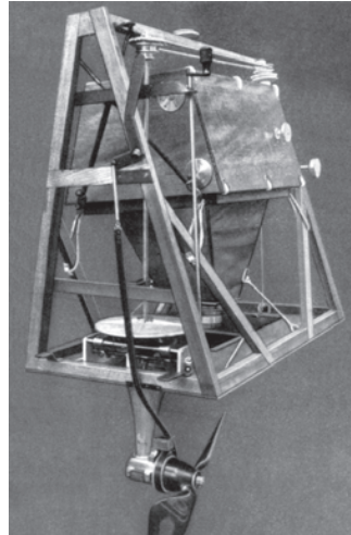
Abb. 24: Der erste »Reihenbildner« von OSKAR MESSTER im Jahre 1915. Der Luftschraubenantrieb lag unter dem Rumpf des Flugzeuges. Ein Reibradgetriebe erlaubte es, die Laufgeschwindigkeit stufenlos zu ändern.
