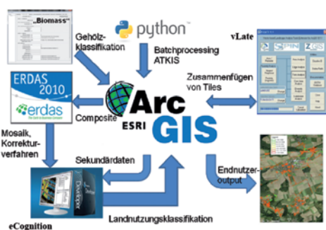
Abb. 1: Schematische Darstellung des work-flows für die Grünlandklassifizierung.
