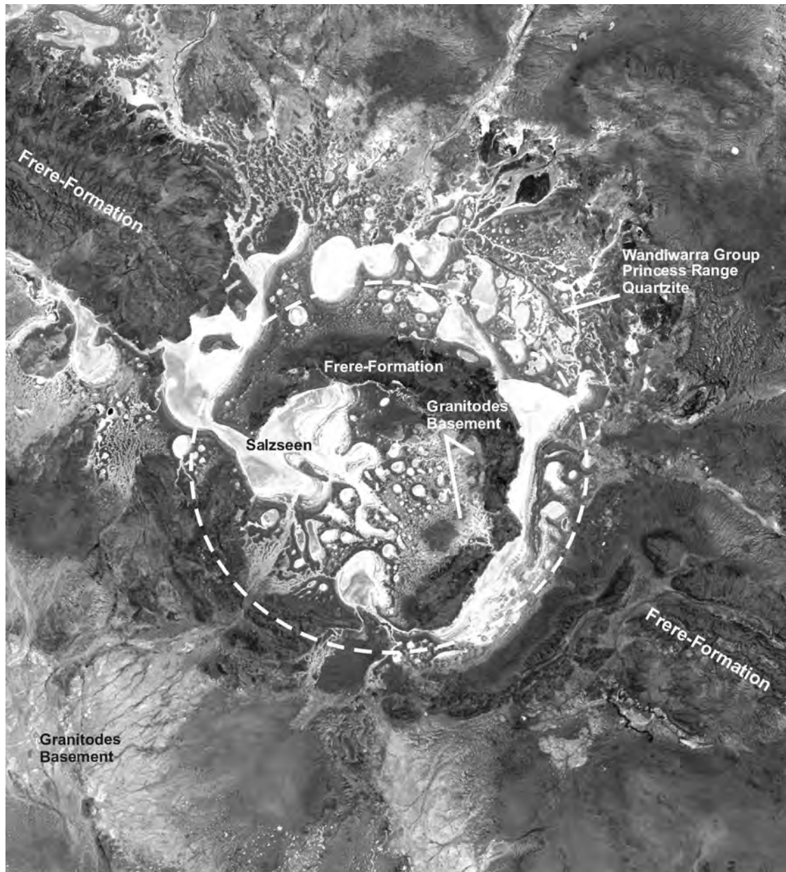
Abb. 2: Landsat-TM-Bild (321 [rgb]) der Shoemaker-Impaktstruktur in Westaustralien. Schematisch angedeutet ist der Verlauf der ringförmigen Synklinale um den granitoiden Kern der Struktur (gestrichelte Linie).
