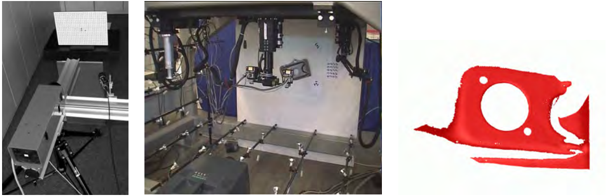
Abb. 3: Links: Labor Aufbau, Mitte: Multi-Sensor Mess-Maschine, Rechts: Datensatz, wie er mit dem mittleren Aufbau erzeugt wurde in schattierter Darstellung.
