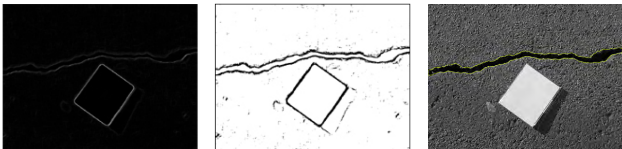
Abb. 8: Segmentierung mit Kantenoperatoren: (links) Kantenbild (Sobel-Operator), (Mitte) binarisiertes Kantenbild nach Schwellwertbildung (rechts) Originalbild mit detektiertem Riss
