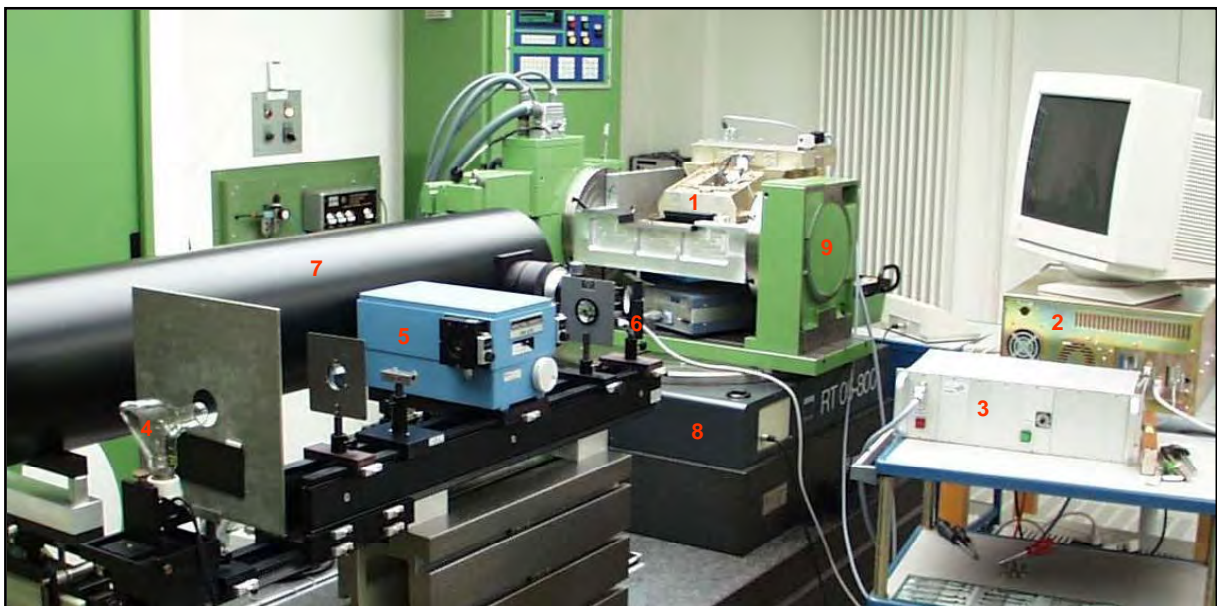
Abb. 4: Laboraufbau für die Spektralkalibrierung mit 1 - ROSIS, 2 - Ansteuerung von ROSIS und Datenspeicherung, 3 - Stromversorgung von ROSIS, 4 - Wolframbandlampe, 5 - Monochromator, 6 - 45°-Spiegel, 7 - Kollimator (off-axis), 8 - Drehtisch (Azimuth), 9 - Drehtisch (Elevation).
