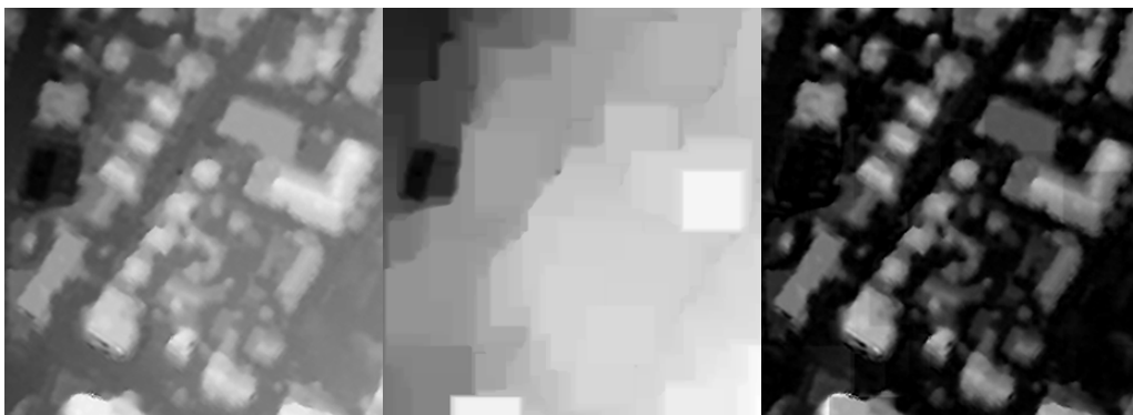
Abbildung 6 zeigt das interpolierte Digitale Oberflächenmodell (links), das durch morphologische Filterung approximierte Digitale Geländemodell (mittig) und das normalisierte Digitale Oberflächenmodell (rechts).
