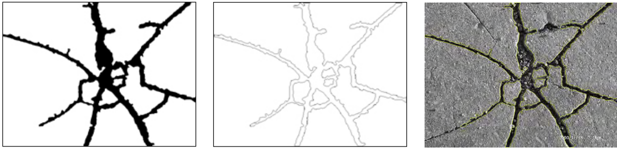
Abb. 7: Regionenwachstum: (links) binarisiertes Bild nach Regionenwachstum, (Mitte) Konturdarstellung der Risskante, (rechts) Originalbild mit detektierten Risskanten
