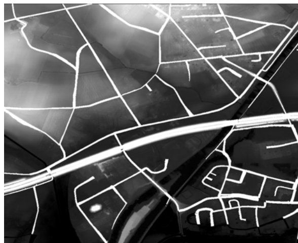
Abb. 4: Ergebnis der Extraktion und Geländemodell für das Gebiet Castrop-Rauxel, Auflösung 0,5 m. Das Ergebnis der Segmentierung ist in weißer Farbe dargestellt.
