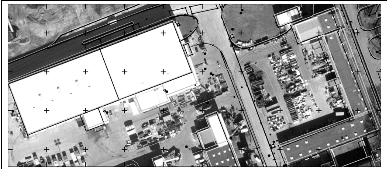
Abb. 8: Orthophoto, überlagert mit dem Lageplan (schwarze Linien) und photogrammetrischer Auswertung (graue Linien). Gitterkreuzabstand: 20 Meter.
