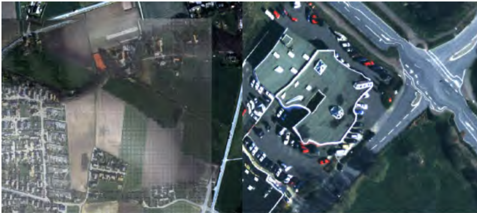
Abb.2: (links) und Abb.3: (rechts) : Auswirkungen fehlerhafter Höhendaten
