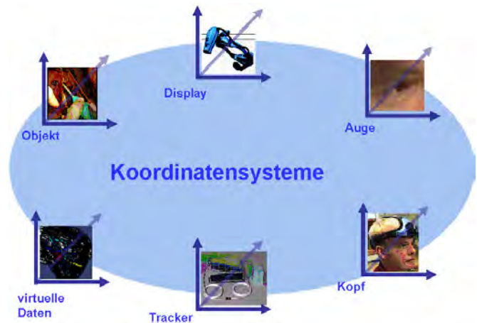
Abb. 1: Koordinatensysteme bei einem Augmented Reality System
