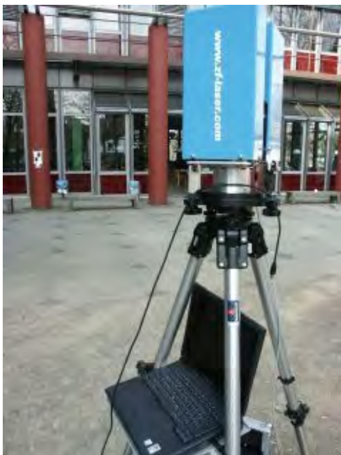
Abb. 2: Messkopf des IMAGER 5003
