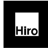
Abb. 5: Beispiel eines Passpunktmarkers
