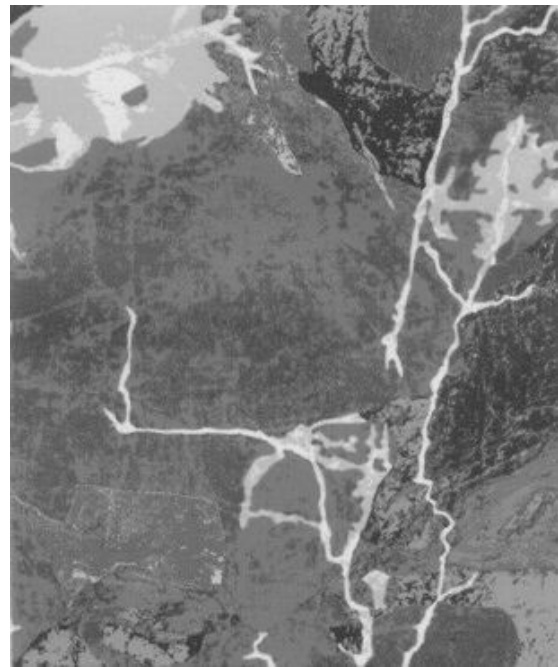
Abb. 4: Ergebnis einer überwachten digitalen Klassifizierung der Geologie des Jébal Hamaret (Blockgröße: 30x40 km)
