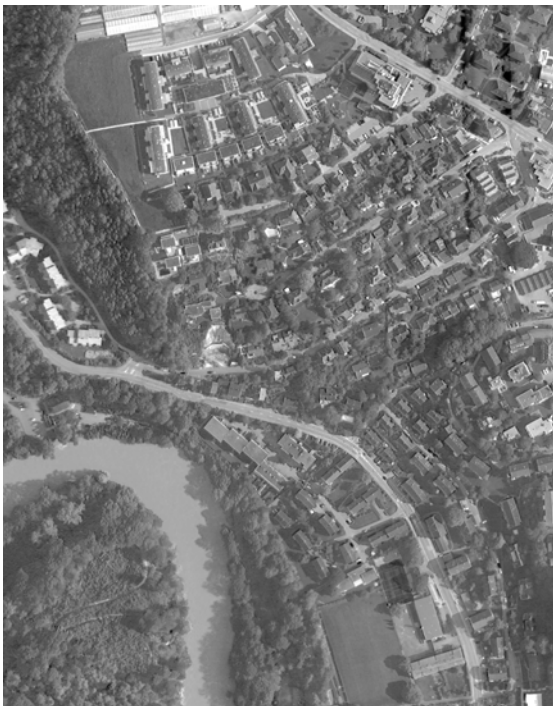
Abb. 4: Beispielhafte Ausschnitte aus Orthobildmosaiken und Digitale Oberflächenmodellen oben: ADS40, Nîmes (Frankreich), Flughöhe ca. 800 m, Bodenauflösung 8 cm unten: HRSC-AX, Bern (Schweiz), Flughöhe ca. 4000 m, Bodenauflösung 18 cm
