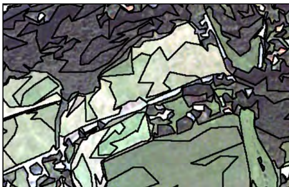
Abb. 7: Segmentierungsergebnis 'Minimum Entropy Approach to Adaptive Image Polygonization'.
