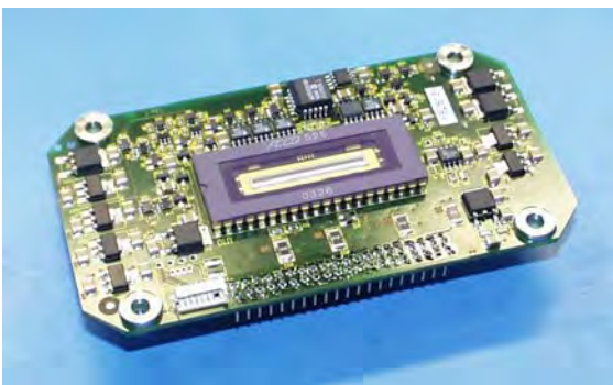
Abb. 2: Fokalebene modul LLPC mit 2k TDI Zeile
