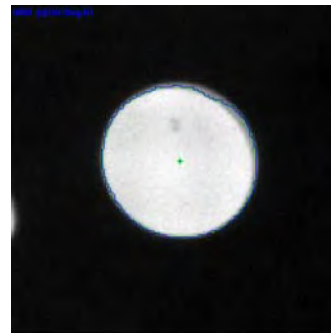
Abb. 5: Bohrungskontur im Durchlicht
