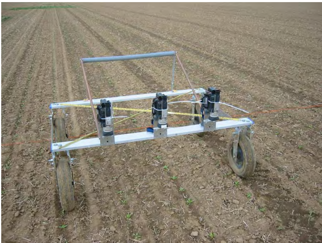
Abb. 2: Der WeedScanner in einem Zuckerrübenbestand bei Rheinbach. An der Frontseite des Fahrzeugs sind 3 digitale 3Chip-CCD Camcorder befestigt, die einen kontinuierlichen Film der Ackeroberfläche erstellen.
