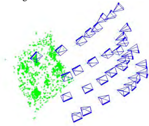
Abb. 5: Datensatz 7 mit 32 Bildern und 3000 zur Orientierung benutzten Objektpunkten
