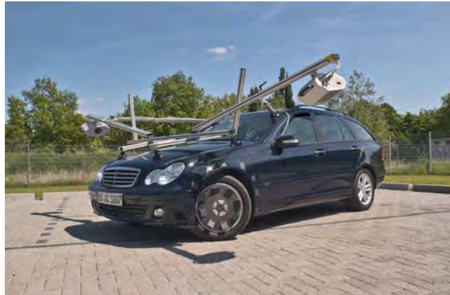
Abb. 5: Messung von Radbewegungen (Wheelwatch)
