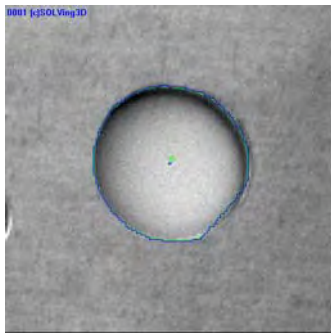
Abb. 4: Bohrungskontur im diffusen Auflicht
