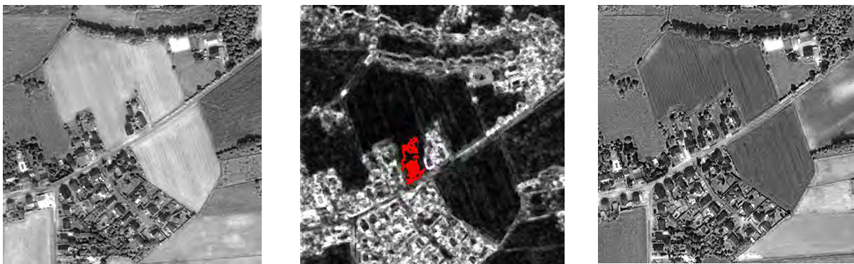
Abb. 4: Erfassung einer Bebauung auf einer landwirtschaftlich genutzten Fläche, die aufgrund unterschiedlicher Nutzungen in 2003 und 2004 als verändert charakterisiert wurde
