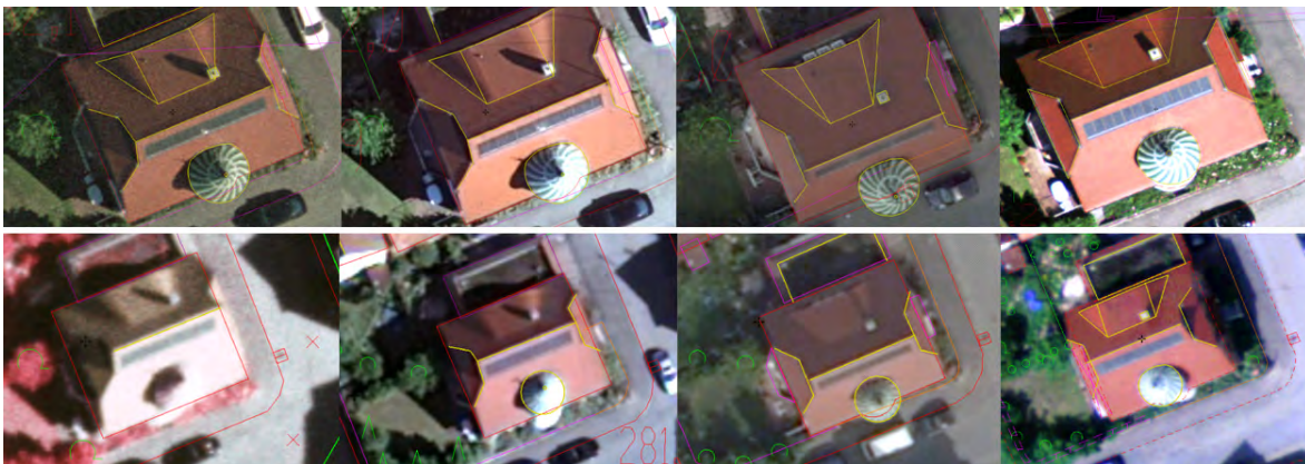
Abb. 7: Detailansicht der Bilddaten. Von links nach rechts: RMK, DMC, UCX, ADS für 8cm GSD (obere Reihe) und 20cm GSD (untere Reihe).
