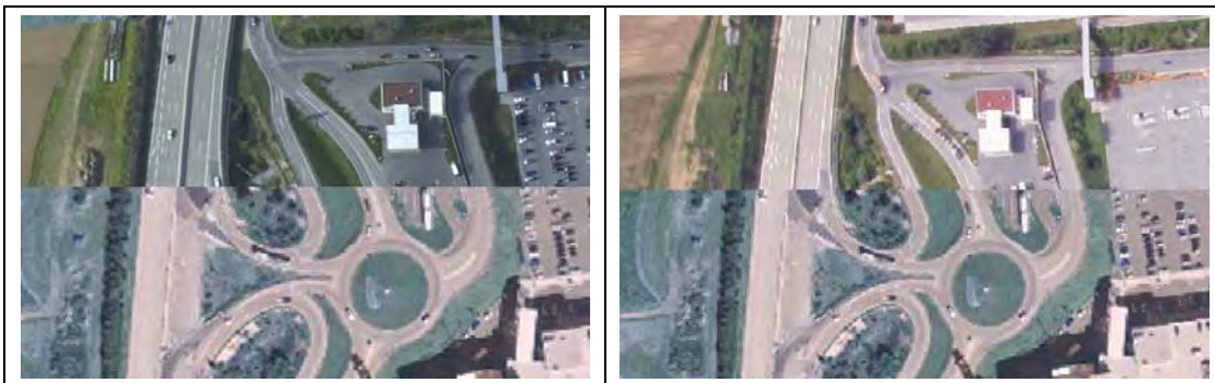
Abb. 4: Absolute Lage-Genauigkeit eines Hasselblad- (links oben) bzw. eines Canon-Orthobildes (rechts oben) im Vergleich zu einem Ortho-Foto (links bzw. rechts unten; Auflösung 1 Meter).
