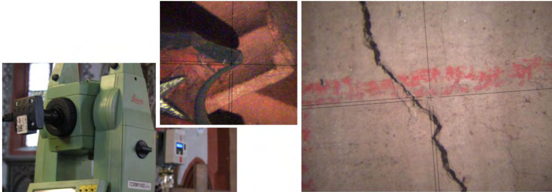
Abbildung 6: Dokumentation von natürlichen Passpunkten für Laserscanning und Photogrammetrie (links) und Rissmonitoring (rechts)
