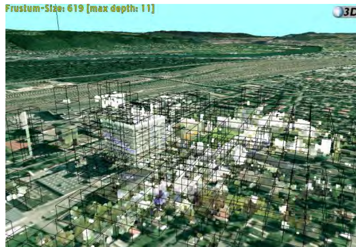
Abb. 5 Sparse Voxel Octree mit einem Punktwolkendatensatz (im Zentrum der Abbildung) in i3D
