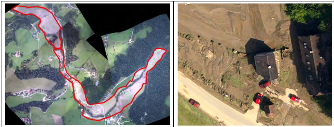
Abb. 6: Wasseranschlagslinie nach einem Hochwasser (links), Mure mit erfasstem Gebäude (rechts)
