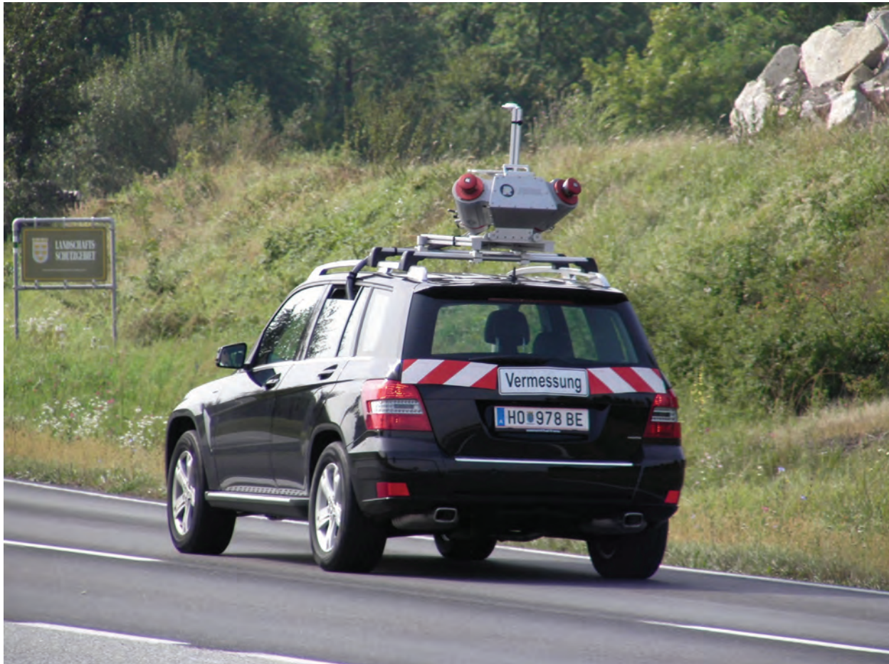
Abb. 1: RIEGL VMX-250 Mobile Laser Scanning System montiert am Vermessungsfahrzeug.
