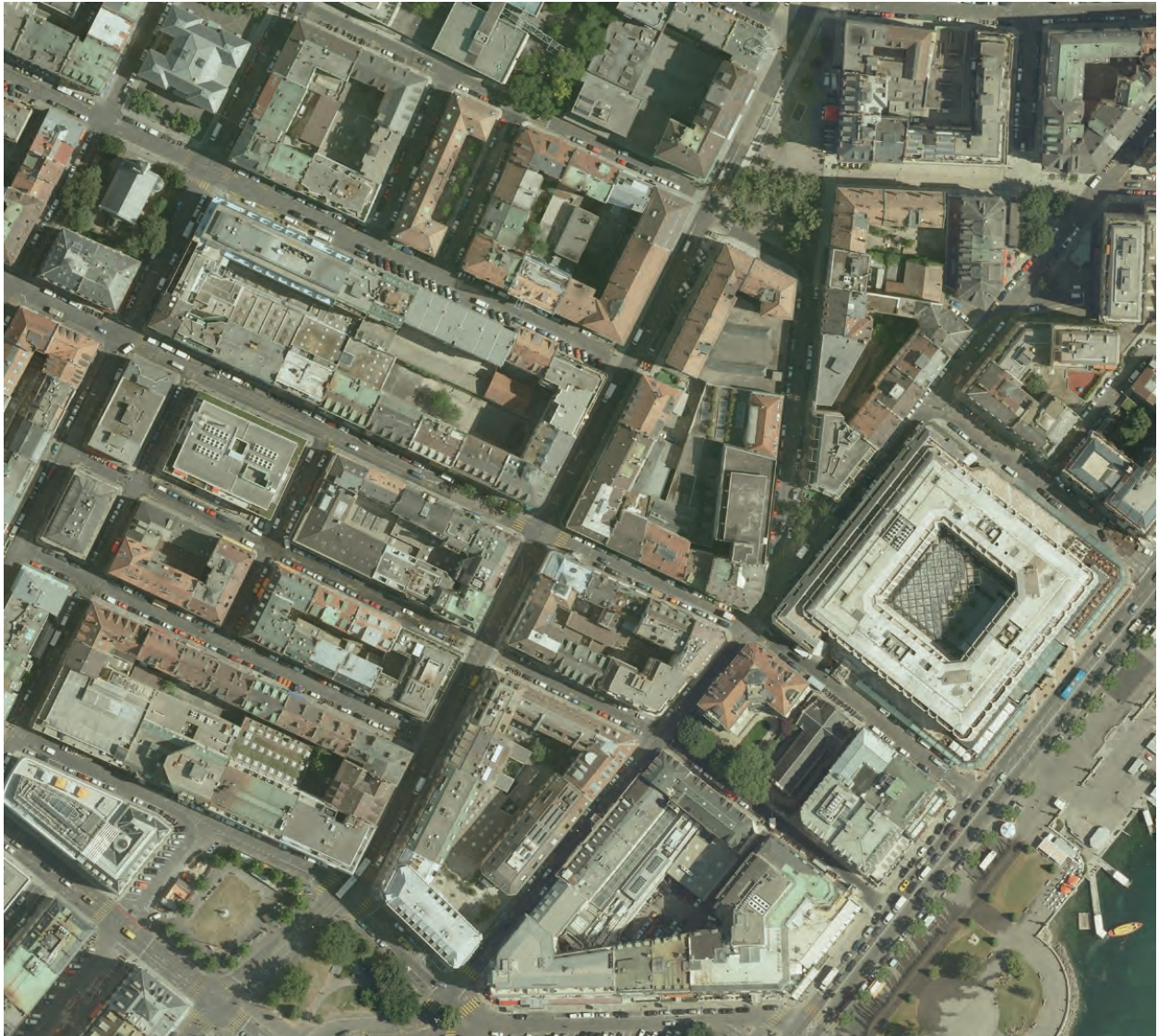
Abb.1: Orthophoto Genf (Befliegung 2009 mit UCXp, 2009, 10 cm GSD, 80% Längs- und 70% Querüberdeckung), Verwendung nur der zentralen Bereiche der Bilder, maximale Verkippung nicht modellierter Objekte bei 17% der Objekthöhe
