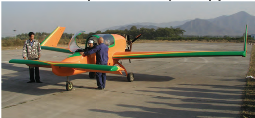
Abb. 7: Eigenbaukonstruktion eines „Entenflüglers“ einer chinesischen Firma mit Ausstattung für Fotoflüge
