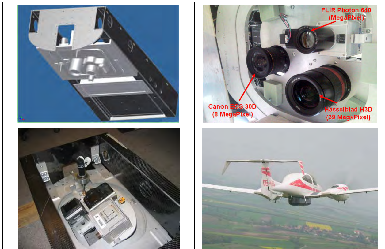
Abb. 2: Design der Aufnahmeplattform (links oben), Integration der Kameras in den BellyPod der DA42 MPP (rechts oben, links unten), sowie integrierte Sensorik im Flugbetrieb (rechts unten).
