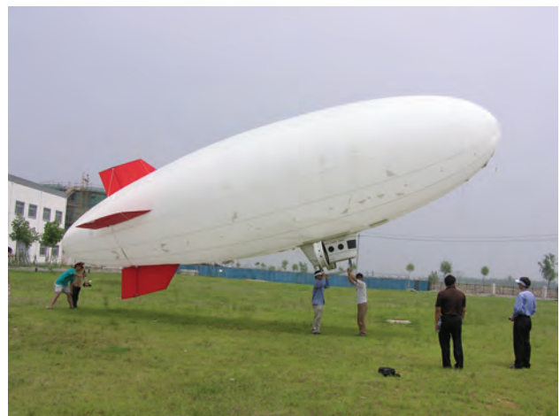
Abb. 2: He-Blimp der Universität Beijing mit Gondel, welche eine stabilisierte Kameraplattform und eine digitale Mittelformatkamera beherbergt.
