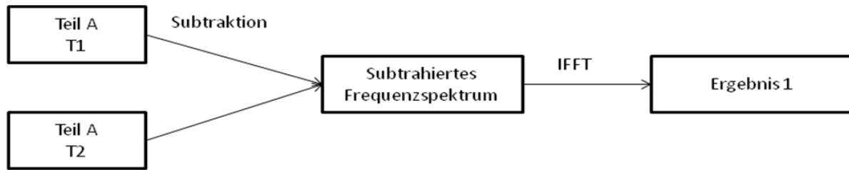
Abb. 3: Subtraktion im Frequenzraum nach Bandpassfilterung
