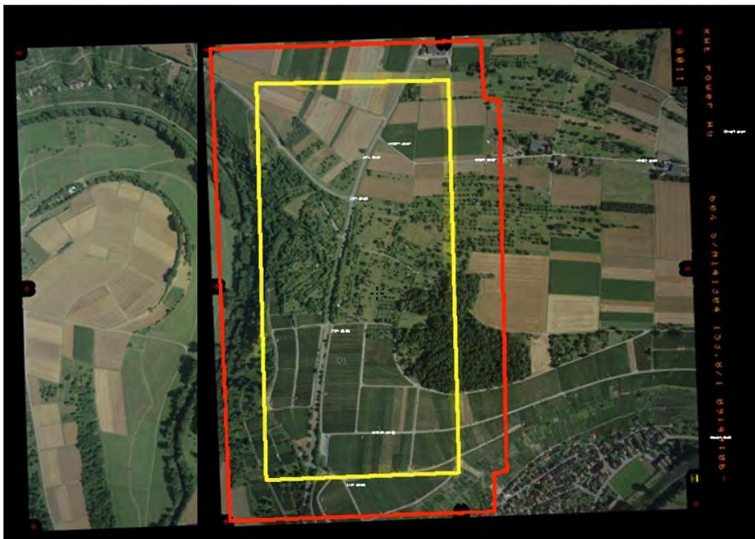
Abb. 13: Übersicht zur mehrfachen Passpunktmessung zur Bestimmung der persönlichen Einstellgenauigkeit: Grenzen des Modellbereiches (gelb) und des Randbereiches (rot), am Beispiel der RMK, 8cm GSD.
