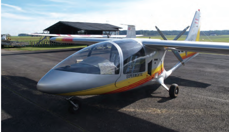
Abb. 8: Experimental Flugzeug der Firma Pauly Luftbildfotographie. Die Kamera samt Plattform wurde am Flugzeug seitlich in einer GFK Box angebracht.
