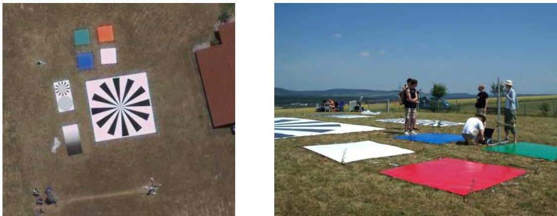
Abb. 2: Vaihingen/Enz Radiometrie Testtafeln aufgenommen aus der Luft (links) und das Bodenteam bei den parallel zu den Bildflügen durchgeführten Spektrometermessungen an den Farbtafeln (rechts).
