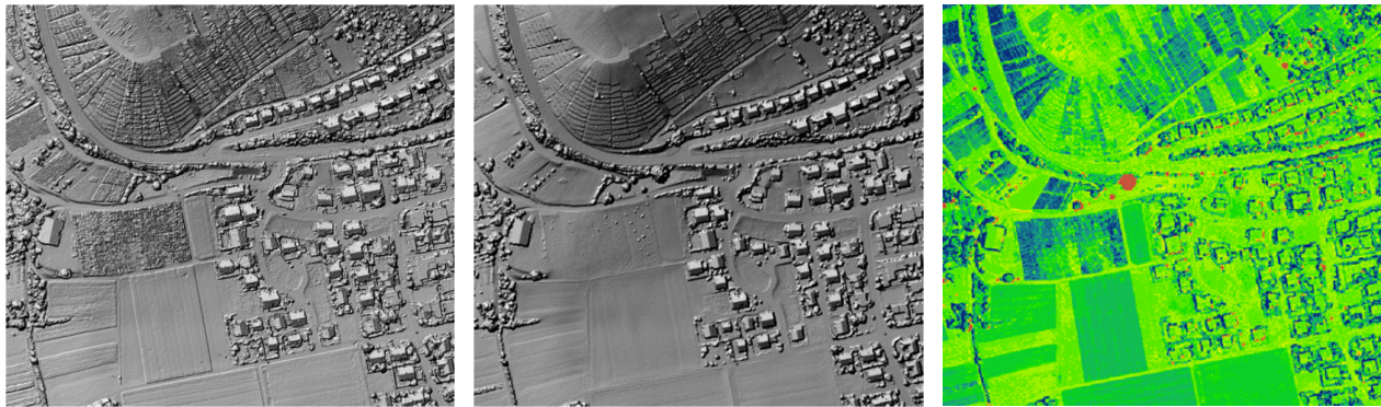
Abb. 4: DOM aus Bildzuordnung (links) und LiDAR (Mitte) und berechnete Differenzen (rechts)
