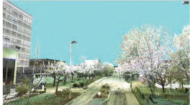
Abb. 8: 3D-Punktwolken-Modell des identischen Ausschnitts mit hoher Punktdichte und mit RGB-Texturen aus ko-registrierten Bilddaten
