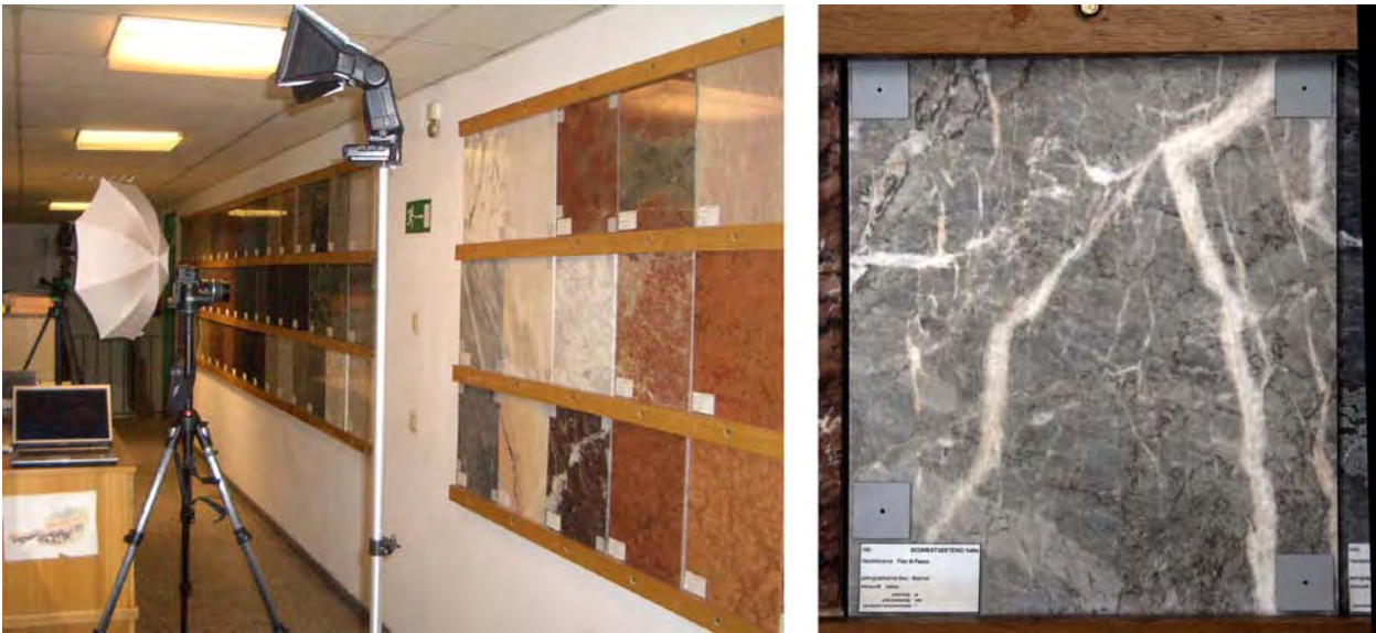
Abb. 3: Bildaufnahme (links) und Testobjekt mit Passmarken (rechts).
