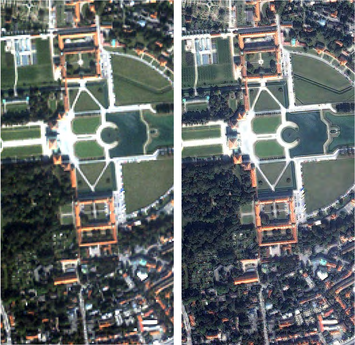
Abb. 3: Farbkomposit aus Daten des Satelliten IKONOS, original mit 4m Auflösung (links), bearbeitet mit verbesserter Auflösung 1 m (rechts)
