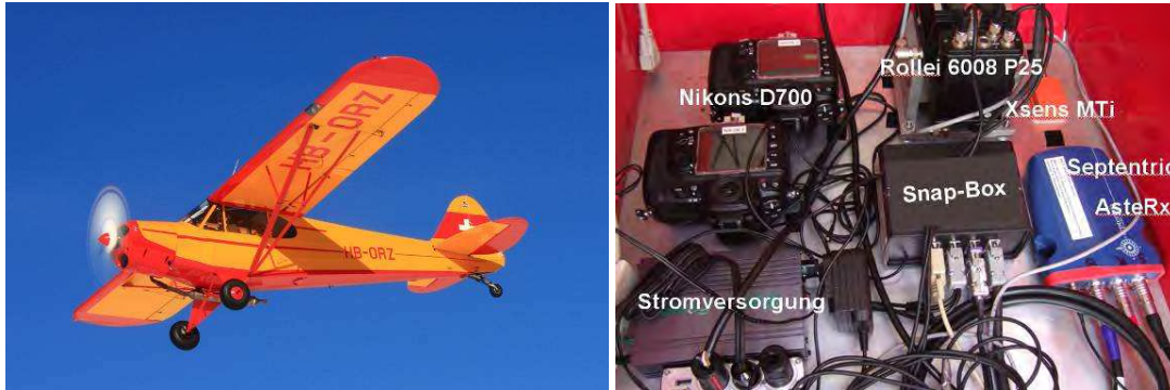
Abb. 4: links: Messflugzeug Piper PA-18 Super Cub rechts: eingebautes airAGro-Aufnahmesystem
