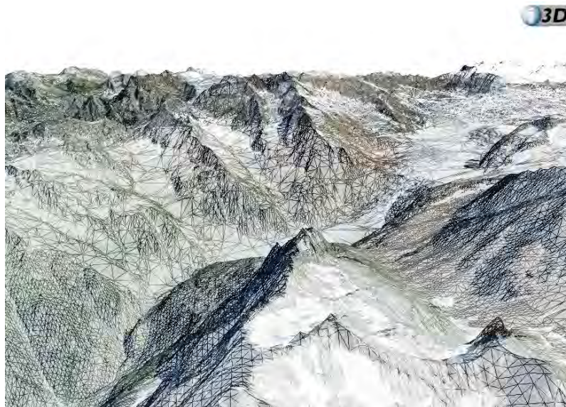
Abb. 4 Bilddaten und Drahtmodell des Höhenmodells zusammengemischt. Basisdaten: DHM 25, SWISSIMAGE © swisstopo (JA100071)
