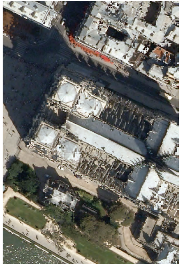
Abb. 3: Versuch eines True Orthophoto auf der Basis eines DSM mit 1 m Gitterweite – unzureichende Modellierung & Doppelabbildungen
