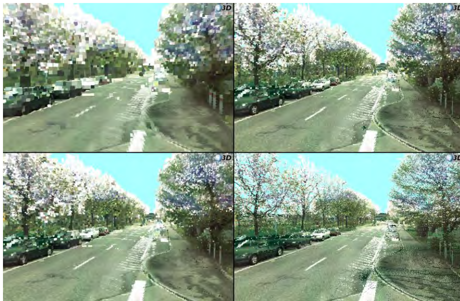
Abb. 8 Voxel basierte 3D-Punktwolke mit RGB-Textur im i3D-Globus in unterschiedlichen Auflösungsstufen. (Oben links in der schlechtesten Auflösung. Unten Links in mittlerer Auflösung. Oben rechts in guter Auflösung und unten rechts in bester Auflösung.)
