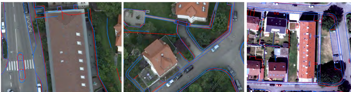
Abb. 12: Links und Mitte: Linienmessungen in RMK (rot) und DMC Bildern (blau), 8cm GSD, überlagert zum UCX Orthophoto, 8cm GSD. Rechts: Vergleich der Linienmessungen RAG (blau) und LGV (rot) überlagert zum DMC Orthophoto, 20cm GSD.
