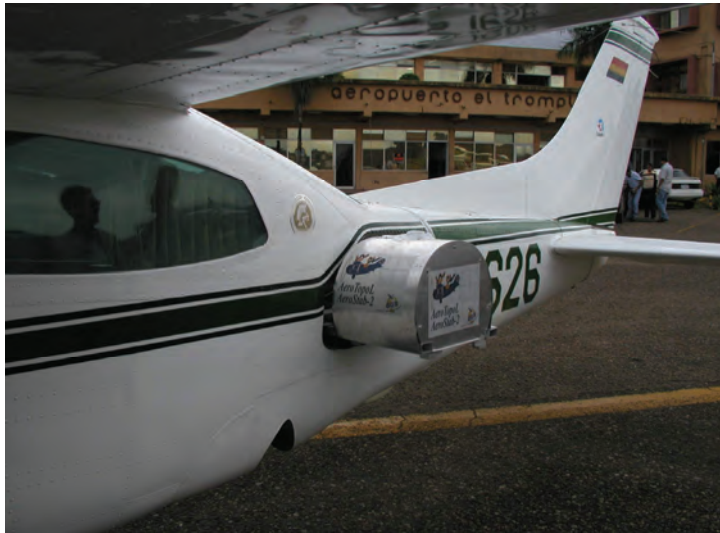
Abb. 10: Außen liegendes Kameragehäuse in Bolivien für das Coca-Monitoring
