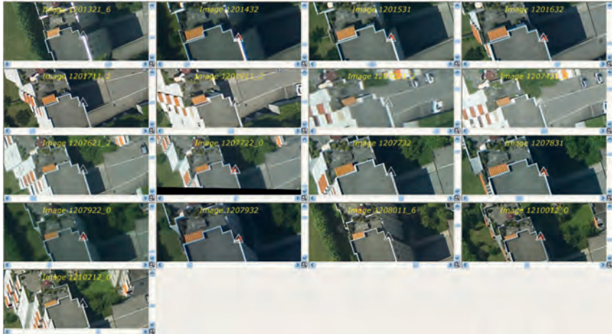
Abb. 3: Manuelle Messung von Verknüpfungspunkten (17 Bilder).
