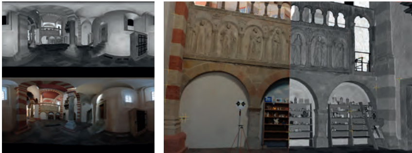
Abb. 2: Links oben: Aus einem Rundumschwenk (PTG-Format) abgeleitetes Remissionspanorama. Links unten: Mit PTGui Pro aus dem Photosatz der Abb. 1 berechnetes Photopanorama. Rechts: Gemeinsame Darstellung von referenziertem Remissions- und Photopanorama in der Software 3D-Panorama-Viewer (gemessene Passpunkte sind mit roten und grünen Kreuzen markiert).
