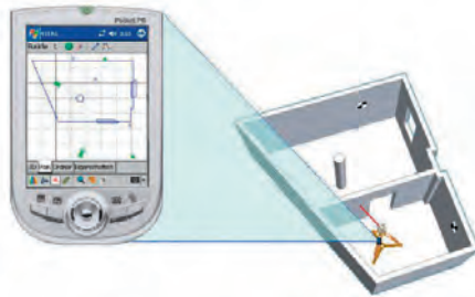
Abb. 2.: Bestandsaufnahme mit dem Tachymeter und der Zusatzsoftware VITAS von der Vitruvius GmbH (VITRUVIUS)
