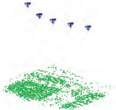
Abb. 4: Räumliche Darstellung der automatisch bestimmten Objektpunkte und der äußeren Orientierungen der Kamerapositionen zu 5 Zeitpunkten einer Befliegung mit einer Drohne.
