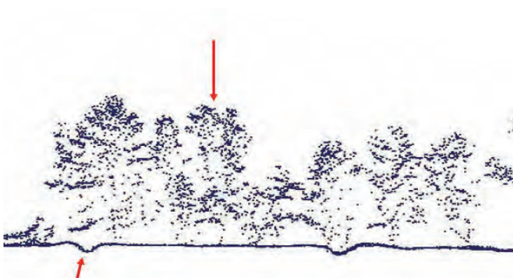
Abb. 7: Detailreichtum einer ALS-Punktwolke bei forstlichen Auswertungen (Quelle: JÜTTE)
