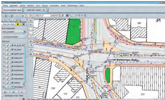
Abb. 3: Kommunale Objekte (ALKIS) und Kanaldaten (ISYBAU-GML) per SLD in SupportGIS-2D 2
