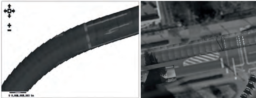
Abb. 4: Beispiel einer Visualisierung von kleinskaligen Orthophotos: Daten vom Messfahrzeug „UNO“; links: Teil eines Autobahnzubringers der A17; rechts: Überlagerung eines Luftbildes mit georeferenzierten Einzelbildern in Dresden
