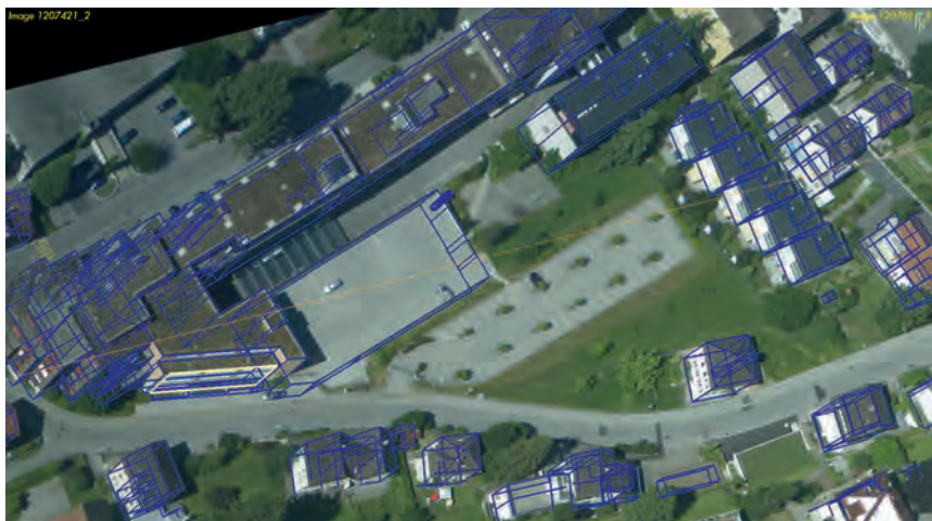
Abb. 4: Qualitätsprüfung durch Rückprojektion von 3D Gebäudedaten in die orientierten Schrägbilder
