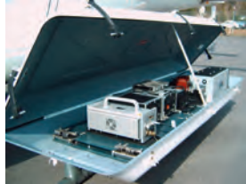
Abb. 4: Eurocopter AS 350, Laserscansystem, RGB-Digital-Framekamera und INS
