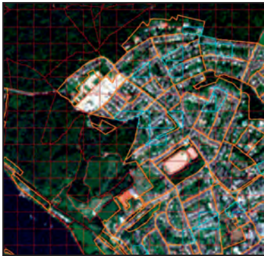
Abb 4: Automatisiert generierte Trainingspolygone innerhalb der Landbedeckungsklasse BS (blau) – sehr hohe, hohe und mittlere Bebauungsdichte.
