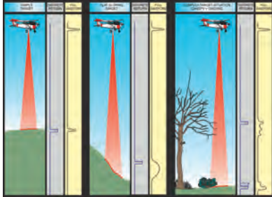
Abb. 5: Signalauswertung als sog. Full Wave Form Analyse
