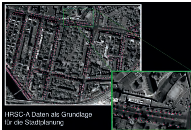
Abb. 1: Hochauflösendes (15 cm) True-Orthobildmosaik Berlin aus dem Jahr 1998, Sensor: HRSC-A, Anwendung: Aktualisierung des Straßenbaumkatasters der ALK.
