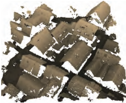
Abb. 15: Gefilterte Punktwolke erzeugt aus Bildpaaren der Konfiguration 5, UltraCamX, 8 cm GSD
