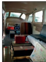
Abb. 2: Innenraum Cessna 207 B 2 Laserscannersysteme sowie INS
