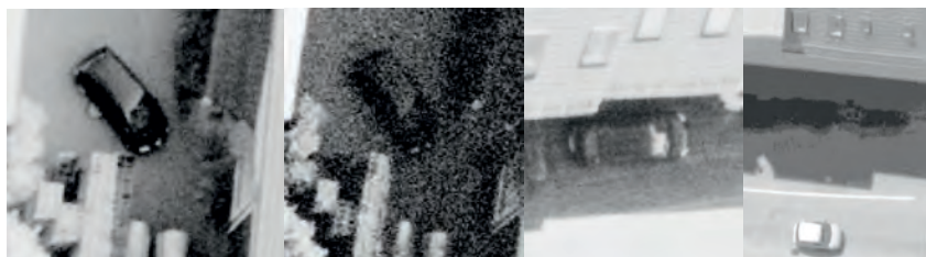
DMC ( \pm 1.1\% ) RMK-Top ( \pm 7.5\% ) ADS-40 ohne Komp. ( \pm 3\% ) ADS-40 mit Komp. Abb. 1: Autos im Schatten mit Angaben zum Rauschen in Prozent der DN-Werte im Schattenbereich, aufgenommen mit verschiedenen Kamerasystemen. Das rechte Bild, aufgenommen mit der ADS-40 wurde bei der Zeilenauslese jpeg-komprimiert. Ein Rauschen ist nicht zur erkennen, allerdings sind auch die Objekte im Schatten nicht mehr zu erkennen.
