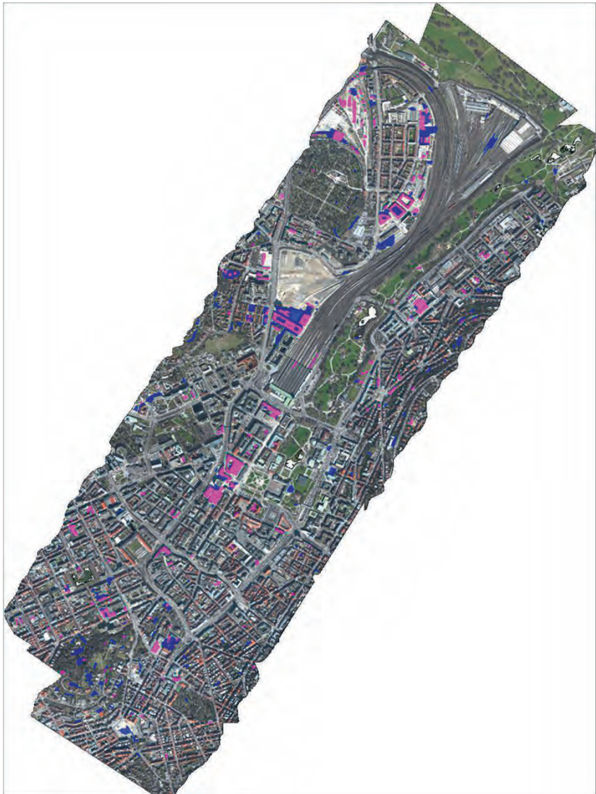
Abb. 5: Ergebnis der objekt-basierten Änderungsdetektion für den gesamten Stuttgarter Teststreifen (Erläuterungen in Abschnitt 4).
