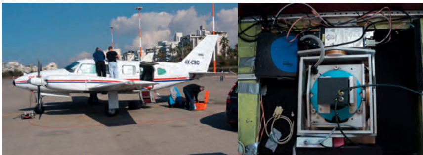
Abb. 3: Piper Navajo stationiert auf dem Flugplatz Sde Dov nahe Tel Aviv (linke Abb.) BGR-AERO-FE-Ausrüstung in Bodenluke montiert (rechte Abb.)
