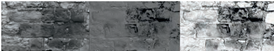
Abb. 1: Grenzen des Auflösungsvermögen eines TLS dargestellt anhand eines Mauerausschnitts. Links: Photo, Mitte: Punktwolke, Rechts: vermaschte Punktwolke
