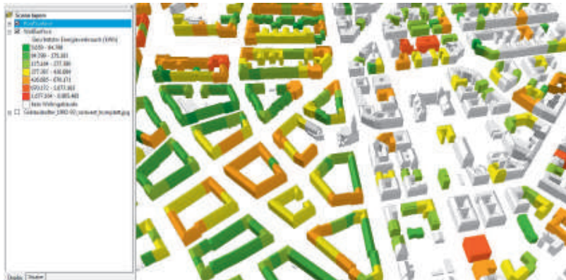
Abbildung 4: Visualisierung der geschätzten Heizenergiebedarfe im Testgebiet Berlin Charlottenburg-Wilmersdorf in Verbindung mit dem 3D-Stadtmodell [CARRIÓN, 2010]
