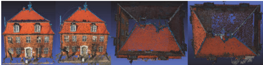
Abb. 7: Baumhaus im Alten Hafen von Wismar – Punktwolke der Frontansicht (links) und des Daches (rechts) mit VisualSFM (jeweils links) und Bundler/PMVS2 (je rechts).
