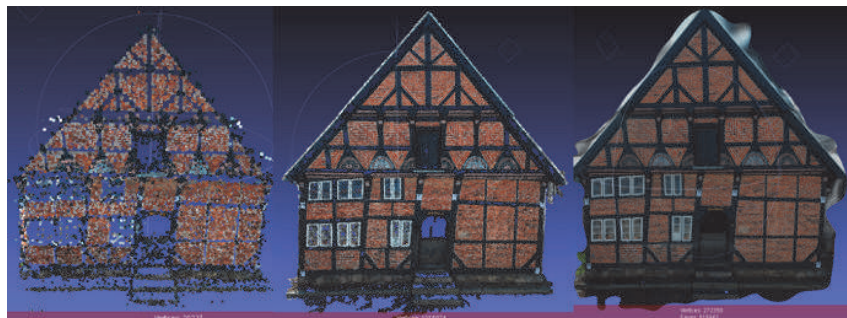
Abb. 4: Frontfassade des Bürgerhauses in Bad Segeberg (19 Bilder der Nikon D90 mit 20 mm Objektiv): Punktwolke aus Photosynth (links) und Bundler/PMVS2 (Mitte) sowie die Dreiecksvermaschung aus Photofly (rechts).
