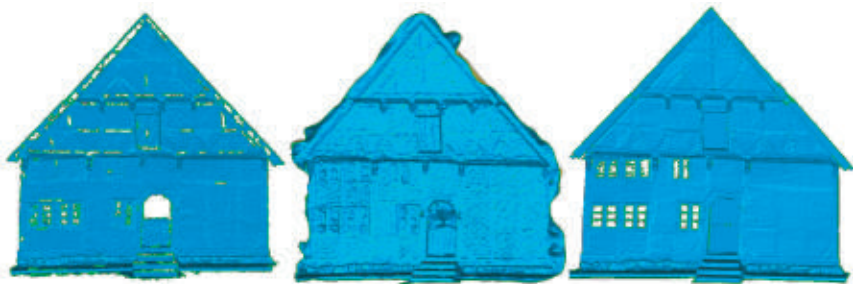
Abb. 5: Dreiecksvermaschung der Frontfassade vom Bürgerhaus in Bad Segeberg: Bundler/PMVS2 (links), Photofly (Mitte) und IMAGER 5006h (rechts).
