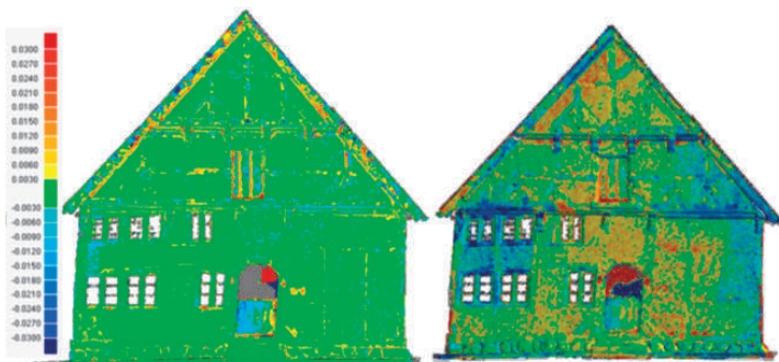
Abb. 6: Registrierung mit ICP von Bundler/PMVS2 zu IMAGER 5006h (links) und 3D-Vergleich mit IMAGER 5006h (grün < 3mm): Bundler/PMVS2 (Mitte) und Photofly (rechts).
