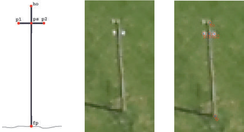
Abb. 3: links: Strommast schematisch, Mitte: Strommast im Bild, rechts: Strommast mit Bildmessung
