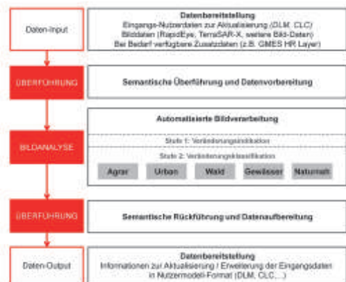
Abb. 2: Schematischer Ablauf der Prozesskette DeCOVER Aktualisierungsdienst
