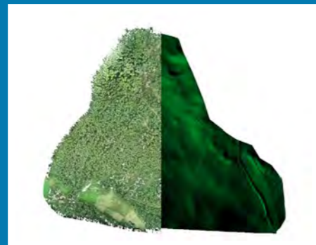
Punktwolke (links) von Waldfläche mit abgeleiteter DGM (rechts)
