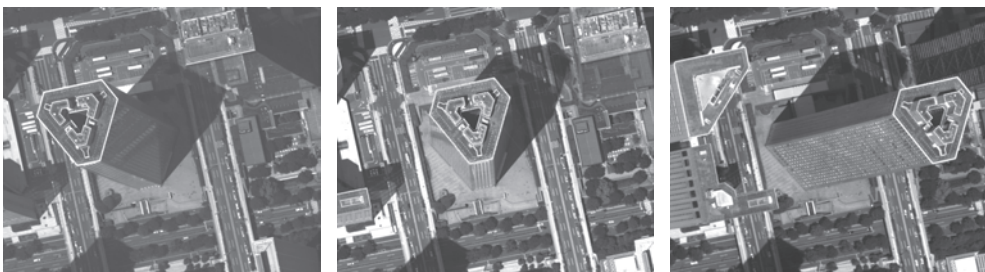
Abb. 4: Shinjuku, Tokyo, Japan. Panchromatische Bilder, Rückwärts, Nadir und Vorwärts. Flughöhe = 2000 m über Grund, GSD = 20 cm. Gesamtbild 12K \times 53K , 25.4 \text{ km}^2 ; gezeigte Ausschnitte 1120 \times 1320 , 5.9 \text{ ha} .
