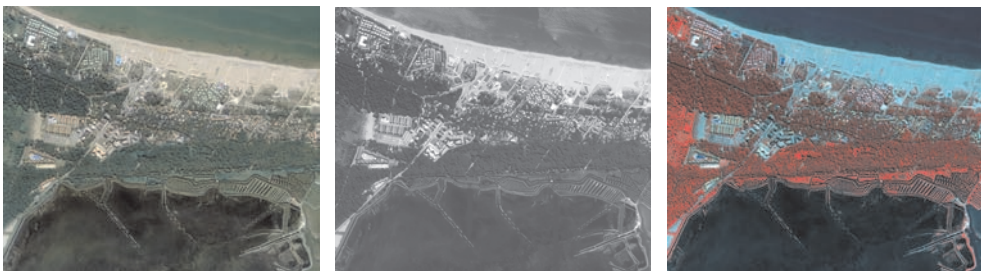
Abb. 1: Adriaküste, Italien. Farbkomposit, panchromatische Nadiraufnahme und Falschfarbkomposit. Flughöhe ü. Grund = 1500 m, Bodenpixel = 15 cm. Alle Bildstreifen entsprechen 12K \times 70K, 18.9 km 2 ; Gezeigte Ausschnitte 12K \times 14K, 3.8 km 2 .
