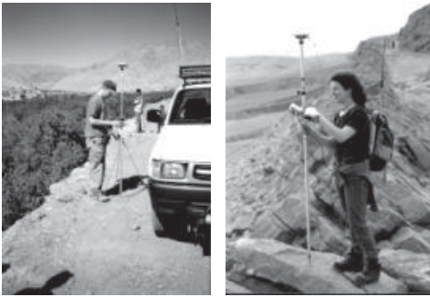
Abb. 8: GPS-Aufnahme mit dem DGPS Leica 300 in Marokko (Foto: A. Altmaier).
