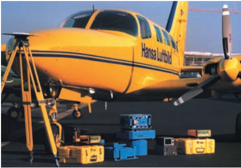
Abb. 11: Bildflugzeug von Hansa Luftbild mit Zeiss RMK-TOP , Trimble 4000 DGPS Gerät und IGI CCNS4 .
