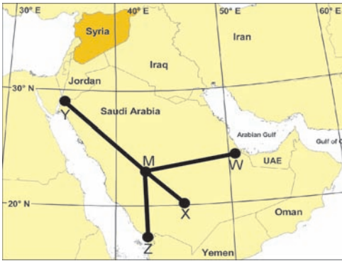
Abb. 7: Das North Saudi Arabian Chain diente als Positionier-Sensor für das CCNS/Loran in der Syrischen Wüste.
