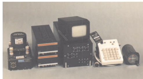
Abb. 10: CCNS3, bestehend aus: Sperry C-13 Kompass, 2x Collins DME-42, IGI Computer und Display, Tastatur und Datacard, sowie CDI.
