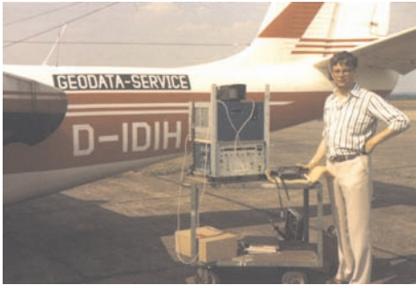
Abb. 1: Geräterack mit Trident-III (unten) sowie CPNS Computer und Display vor dem Einbau in das Flugzeug.
