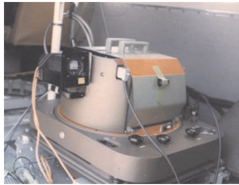
Abb. 4: Der Wild RC10A Prototyp mit künstlichem Horizont; im Hintergrund ist ein Alu-Rohr zu erkennen, an dem die nach unten gerichtete Trident-III Antenne befestigt war.
