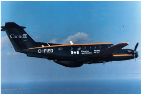
Abb. 9: King Air B200 Special Mission Flugzeug, ausgerüstet mit IGIs Multi-Sensor-System.
