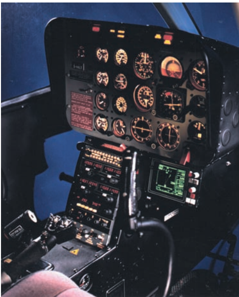
Abb. 13: Eine 5 Zoll CDU des CCNS4 , eingebaut in einen Hubschrauber vom Typ BELL Longranger .
