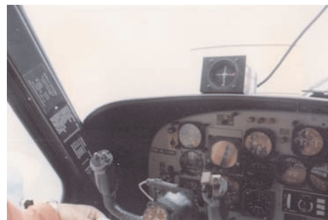
Abb. 3: DFVLR Dornier Do-28 mit CDI Instrument der Trident Anlage.
