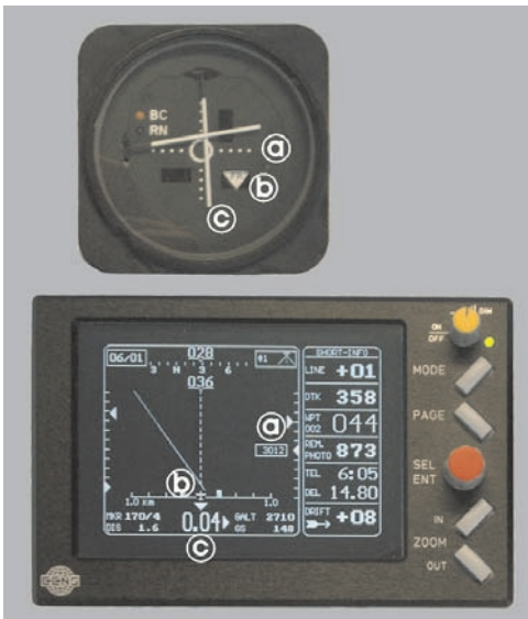
Abb. 2: Das Bild stellt zwei verschiedene Fluginstrumente dar, die beide die gleiche Basis-Information wiedergeben.
