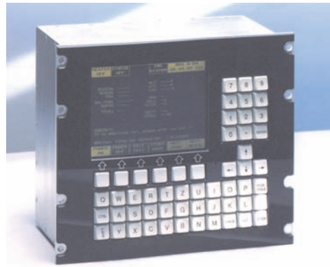
Abb. 19: Das von IGI entwickelte und gebaute Bediengerät BDG A-84 für die russische ZENIT A-84 Panoramakamera.
