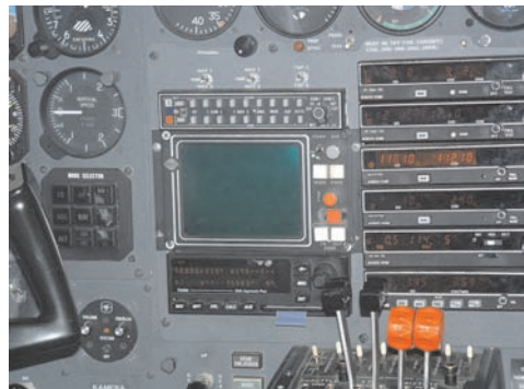
Abb. 3: Kontroll- und Anzeigeelement des CCNS4 , integriert im Instrumentenbrett eines Vermessungsflugzeuges von Hansa Luftbild.
