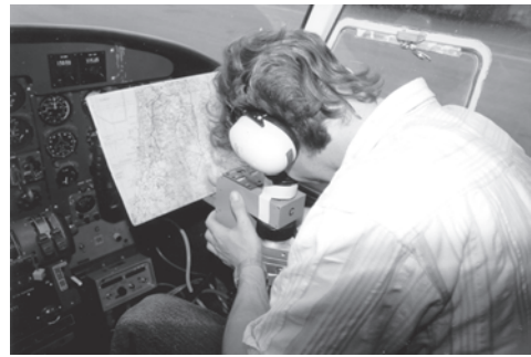
Abb. 2: Sichtnavigation mit Teleskop.
