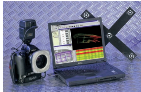
Abb. 3: Industriemesssystem mit Digitalkamera.
