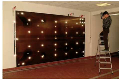
Abb. 2: Ebenheitsmessung am Solar-Panel.
