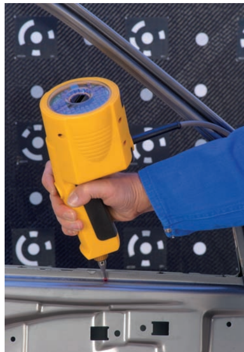
Abb. 5: Messsystem mit aktivem Taster.
