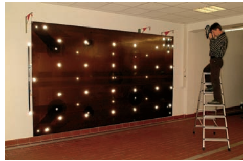
Abb. 2: Ebenheitsmessung am Solar-Panel.
