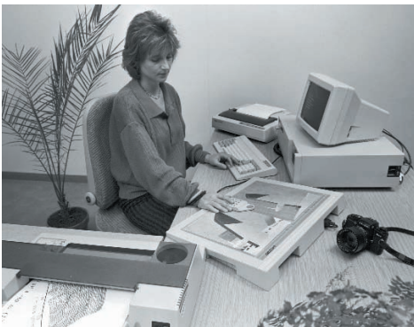
Abb. 1: Komponenten eines photogrammetrischen Low-Cost-Systems (um 1986).
