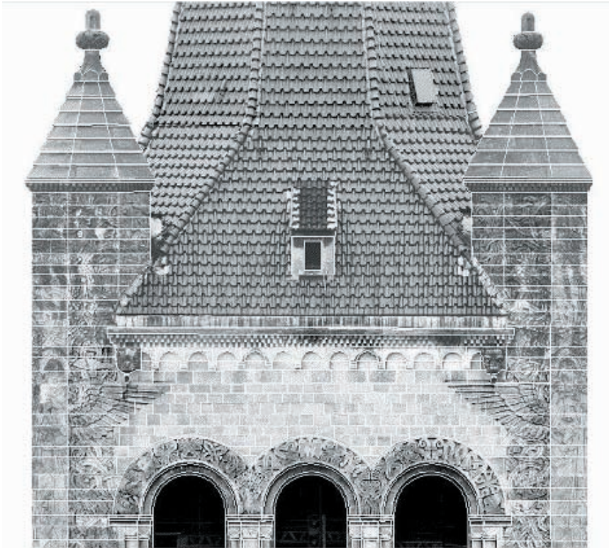
Abb. 5: 3D-Modell mit automatisch generierten Flächenfüllungen aus entzerrten Bildteilen.
