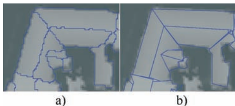
Abb. 4: Ausschnitt des DOM für das Gebäude aus Abb. 2 mit überlagerten Dachpolygonen. a) Die ursprünglichen Pixelketten aus Abb. 3d; b) nach der Detektion von Verschneidungen und Höhengsprüngen.
