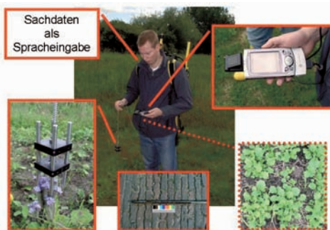
Abb. 3: Mobiles Umwelt-GIS mit Positionsbestimmung per DGPS und Hyperspektralsensor, Spracheingabe und Fotodokumentation.
