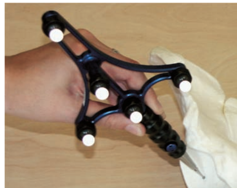
Abb. 5: Handtaster mit optischer Schaltfunktion (AXIOS 3D).
