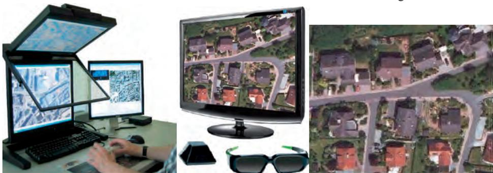
Monitore zur Stereobetrachtung mit passiven Polarisationsbrillen (links) und Shutterbrille (Mitte), Luftbildausschnitt (rechts)
