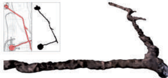
Abb. 5: Perspektivische Ansicht der Rösche (groß); Lageskizze und Aufsicht 3D-Modell (links oben).
