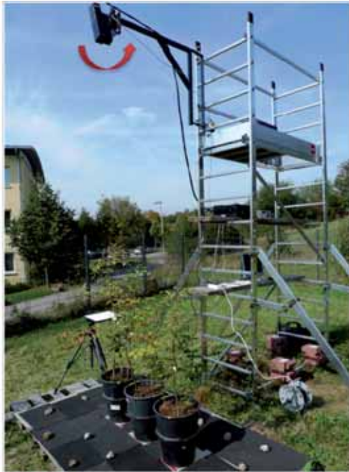
Abb. 2: Versuchsaufbau für die Hyperspektralaufnahmen. Die Bewegungsrichtung des Sensors ist mit dem Pfeil angedeutet.
