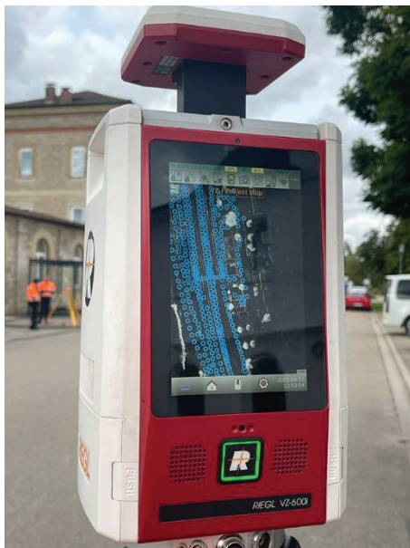
Abbildung 1: RIEGL VZ-600i Laserscanner mit den bereits automatisch registrierten Scanpositionen
