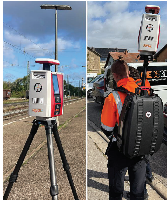
Abbildung 3 Der Laserscanner im statischen (links) und im kinematischen (rechts) Einsatz
