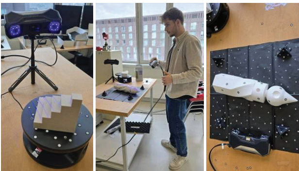
Abbildung 3 Scannen des Treppenmodells auf dem Drehteller mit MetroX (links) und Scannen des Testy auf einer schwarzen Kunststoffmatte mit Zielmarken (Mitte und rechts)
