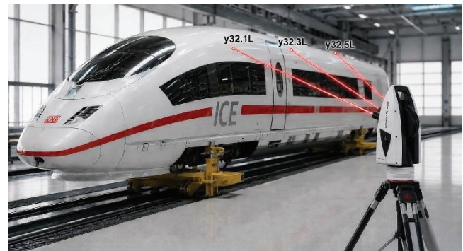
Abbildung 2 Seitenwandmessungen (Messstellen Y32) mit einem Lasertracker (Originalbild durch KI modifiziert)
