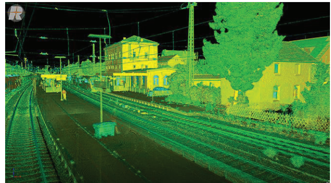
Abbildung 2: Punktwolke Bahnhof Steinach, eingefärbt nach „Reflectance“ (mit „Point Shading“-Visualisierung).
