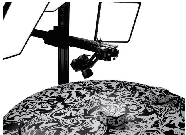
Abbildung 1 Automatischer Drehtisch mit manuellem Auslegerstativ zur photogrammetrischen 3D-Digitalisierung
