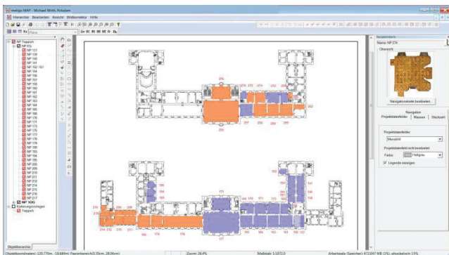
Abbildung 5 Digitale Kartierung mit Projekthierarchie in metigo® MAP 4.0; Links: Navigationskarte Projekthierarchie mit Einfärbung der Projekte nach Projektdatenfeldern; Potsdam, Neues Palais, SPSG; Kartierung/Maßnahmenplanung: Dipl.-Rest. Michael Wirth, Potsdam (2014, SPSG)
