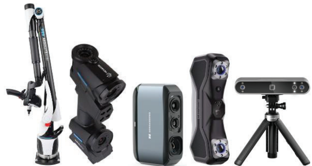
Abbildung 1 Handgeführte 3D-Scanner für geometrische Untersuchungen (v.l.n.r.) – Hexagon Absolute Arm mit AS1-Scanner, Hexagon MARVELSCAN, 3DMakerPro Moose, Revopoint MetroX und Revopoint Pop3 Plus (Die Darstellung der Systeme ist nicht maßstabsgetreu)
