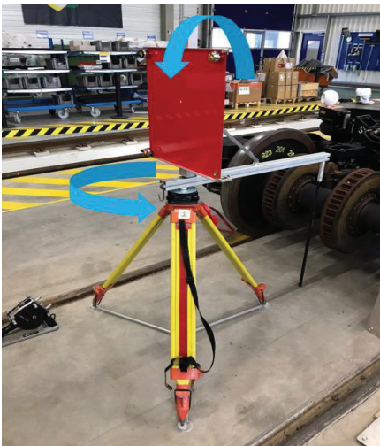
Abbildung 3 Rotes Stahlblech auf Kippvorrichtung
