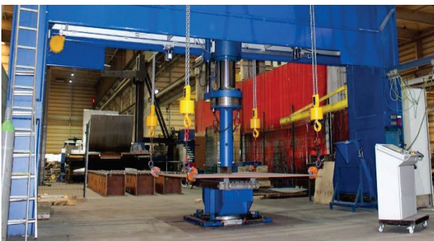
Abbildung 1 Portal mit Pressstempel
