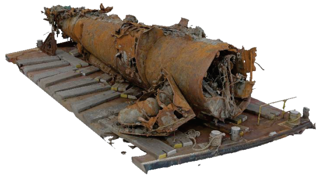
Abbildung 3 Screenshot 3D-Modell Bugsektion S.M. U-16 (Bild: Hoffmann/Junge)
