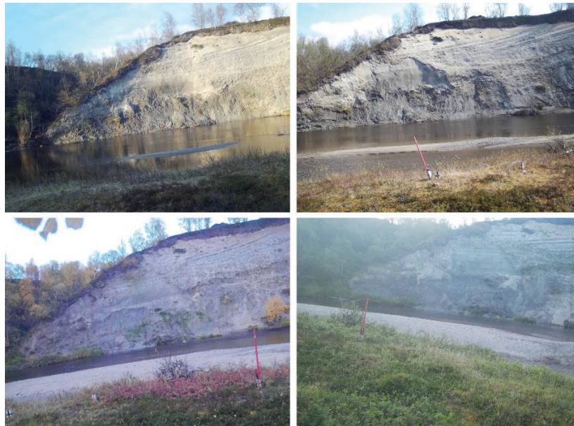
Abbildung 1 Beispielhafte Aufnahmen des Flussufers. Änderungen der Lichtverhältnisse (oben links zu oben rechts), Umwelteinflüsse wie Nebel (unten rechts) oder Bildartefakte (unten links) erschweren die Bildpunktzuordnung mit SIFT aufgrund der radiometrischen Unterschiede.
