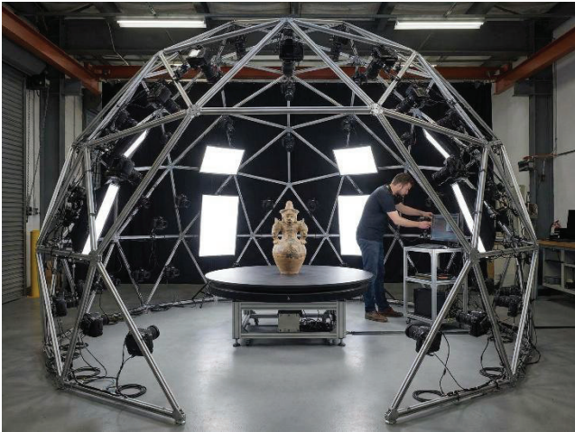
Abbildung 2 Gerätelösung mit sphärisch angeordneten Kameras (Symbolbild)
