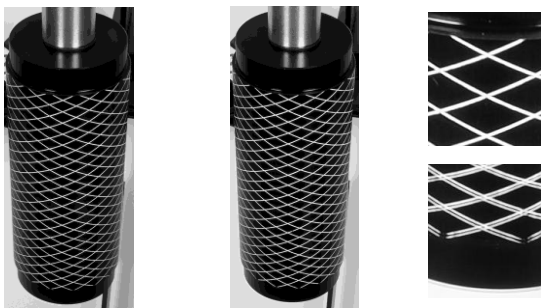
Abbildung 13 Probeaufnahme zum Nachweis der berechneten Pixelfehler (mit Glasplatte)
