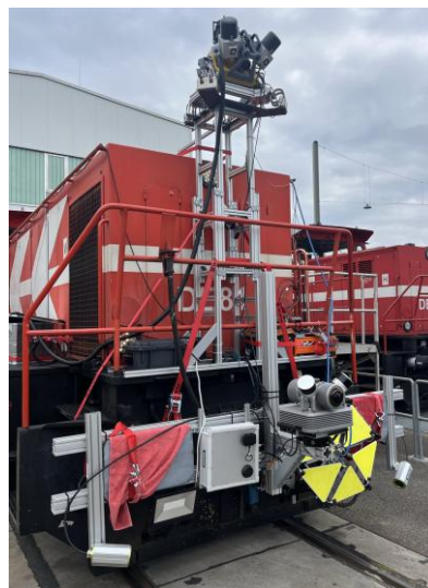
Abbildung 1 MSS auf Trägerplattform, kombiniert mit Zusatzkameras und GV-Target (Beispiel).
