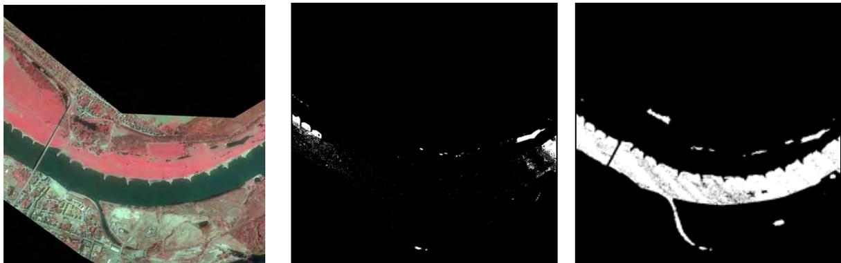
Abbildung 5: Ableitung von Wasserflächen aus dem Testdatensatz Elbe
