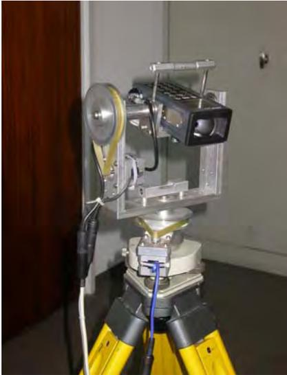
Abb. 5: Prototyp Laserscanner
