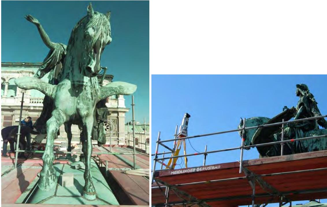
Abb. 1: Links: Die zu modellierende Pegasus-Statue auf der Wiener Staatsoper. Rechts: Der Laserscanner Riegl LMS-Z420i im Einsatz (Foto: Riegl LMS).
