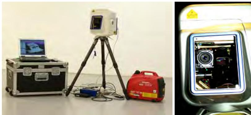
Abb.1: Das 3D-Laserscanning-System Mensi GS100 der HAW Hamburg mit Zubehör (links) und als Innenansicht mit digitaler Kamera und Spiegel (rechts)
