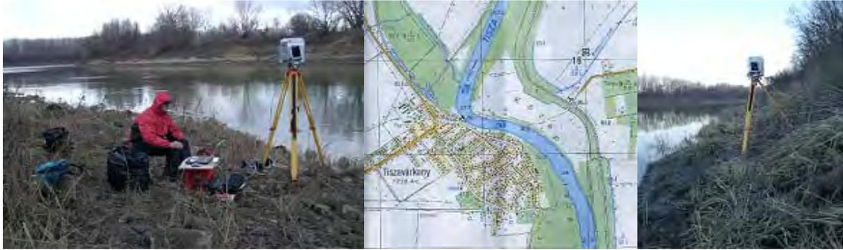
Abb. 6: Mensi GS200 im Einsatz am Fluss Tisza (links), Kartenausschnitt des Projektgebietes bei Tiszavárkony (Mitte) und der Scanner in der rutschigen und lehmigen Uferböschung
