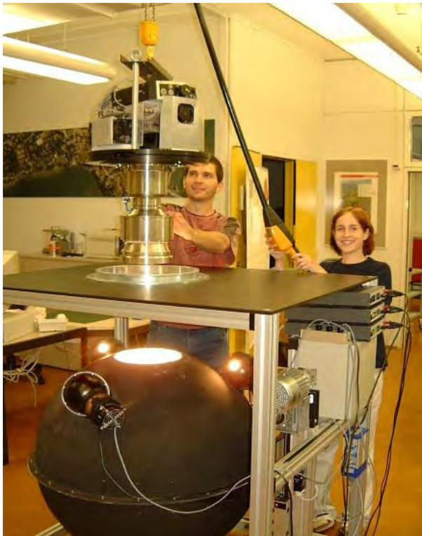
Abb. 1: Ulbrichtkugel zur Kalibrierung.
