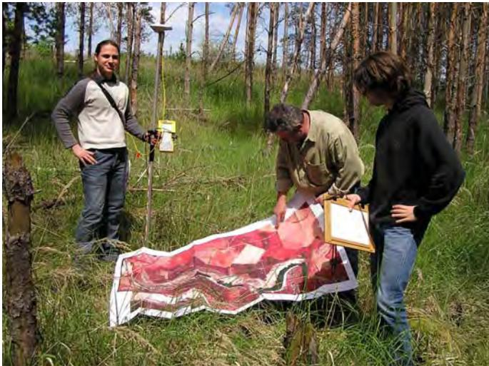
Abb. 4: Passpunktmessung mit Hilfe einer Trimble GPS-Ausrüstung
