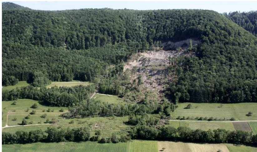
Abb. 1: Hangrutschung Talheim-West (Nordflanke Buchberg) im Sommer 2013. Das Gelände ist Anfang Juni 2013 innerhalb weniger Tage aufgrund von Starkregenereignissen abgerutscht.
