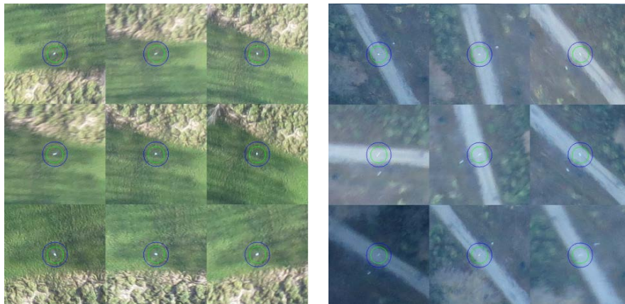
Abb. 5: Signalisierte Punkte in den GSD 8cm Bildern (Auszug aus Terra3D Report). Im linken Teil ist exemplarisch Punkt 3 im sonnenbestrahlten Teil des Geländes, im rechten Teil Punkt 19 im schattigen Hangbereich gezeigt. Es handelt sich jeweils um Ausschnitte aus 9 verschiedenen Bildern. Aufgrund der hohen Überdeckung können die signalisierten Punkte in bis zu max. 36 überlappenden Bildern gemessen werden. Die Unschärfen in einigen Bildern sind zu erkennen.
