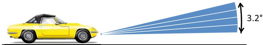
Abb. 4: Anordnung und vertikaler Sichtbereich des Automotive Laserscanners.
