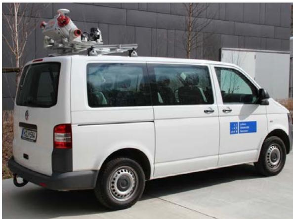
Abb. 2: Riegl VMX-250 Mobile-Mapping-System
