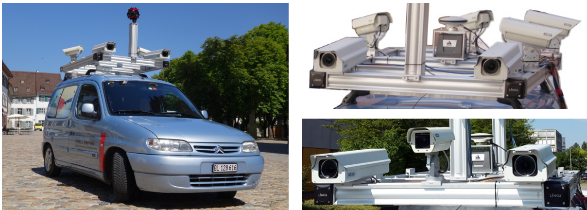
Abb. 1: Mobile Mapping System des IVGI (links), Sensor-Konfiguration für die Messfahrt Juli 2014 (rechts oben) und für die Messfahrt August 2015 (rechts unten)
