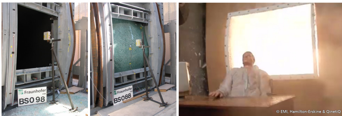
Abb. 5: Experimentelle Stoßwellentests an normalem Glas (links) und Sicherheitsglas (Mitte). Experimentelle Erprobung einer Schutzmaßnahme für Mauerwerk (rechts).
