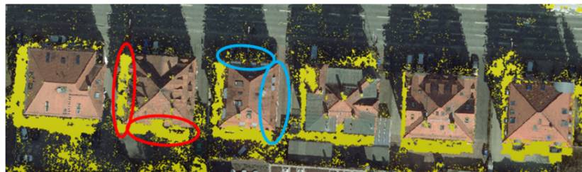
Abb. 2: Detailausschnitt der Punktwolke am Rand des Luftbildverbandes (Datenlücken: gelb)
