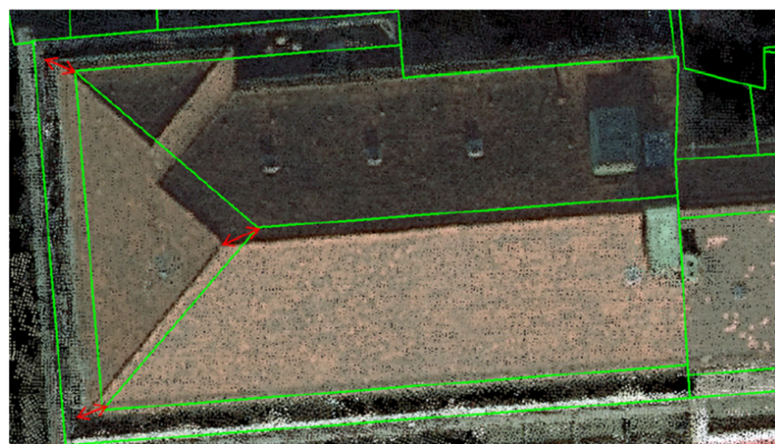
Abb. 6: Vergleich Punktwolke – LoD2 Daten
