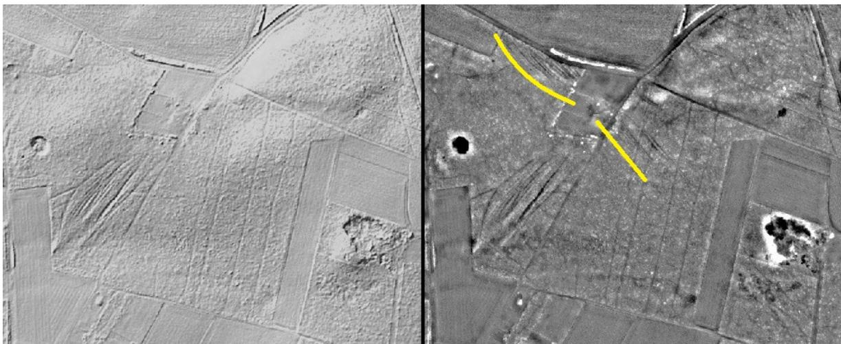
Abb. 2: Vergleich einer herkömmlichen Schummerungsdarstellung (links) und einer *Difference Map* (rechts) nach Hesse: Links fehlen beleuchtungsbedingt die Hohlwege in NW-SO-Richtung. Rechts sind alle Strukturen gut zu sehen (gelb), da die Visualisierung ohne Beleuchtung arbeitet.
