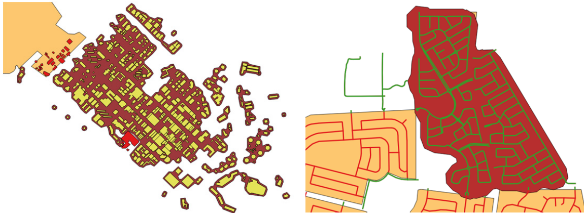
Abb. 4: Selektion von Gebäuden bzw. Straßen (links/rechts; jeweils grün) und deren Verschmelzen nach Pufferbildung (braune Flächen)
