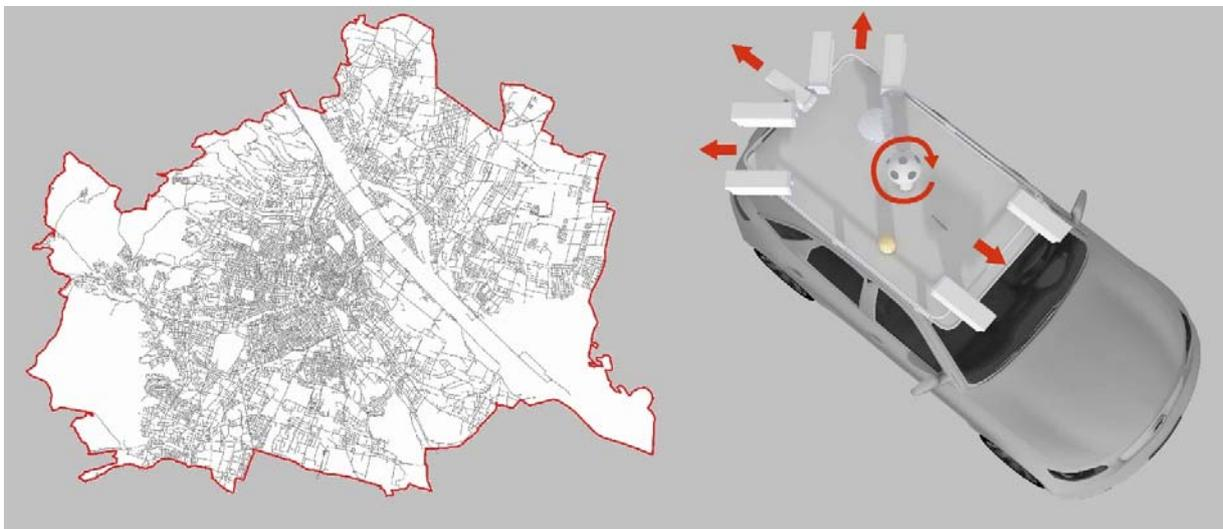
Abb. 1: Links: Wiener Straßennetz mit rund 3000 km Achsen, Rechts: Unterschiedliche Kamerasysteme auf den Mobile Mapping Fahrzeugen (3 Stereokameras, 1 Panoramakamera, 1 Monokamera).
