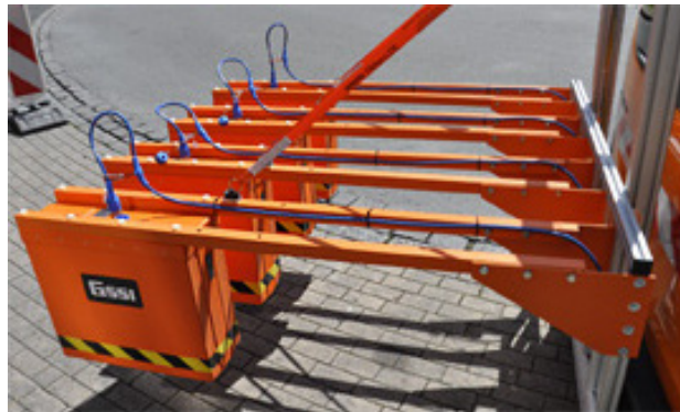
Abb. 7: An das Messfahrzeug montierte Bodenradarantennen.
