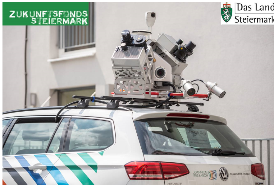
Abb. 2: Installation des Mobile Mapping Systems auf einem JR Firmenfahrzeug (Foto: B. Bergmann)
