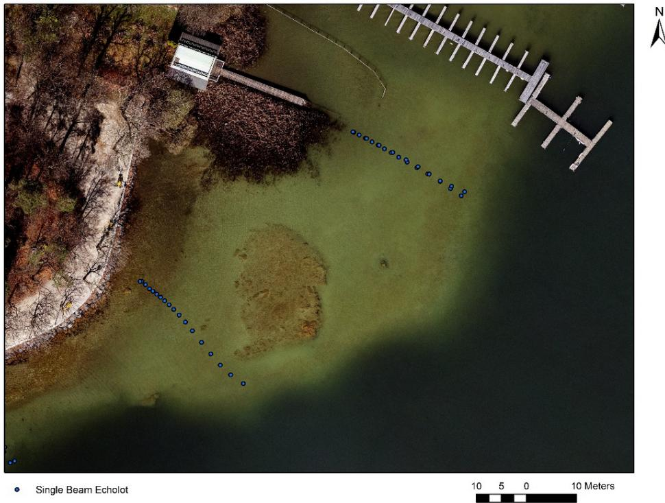
Abb. 2: Detailausschnitt Orthophoto (2.27 cm/Pixel) & Single Beam Referenzpunkte im Bereich Krumpendorf
