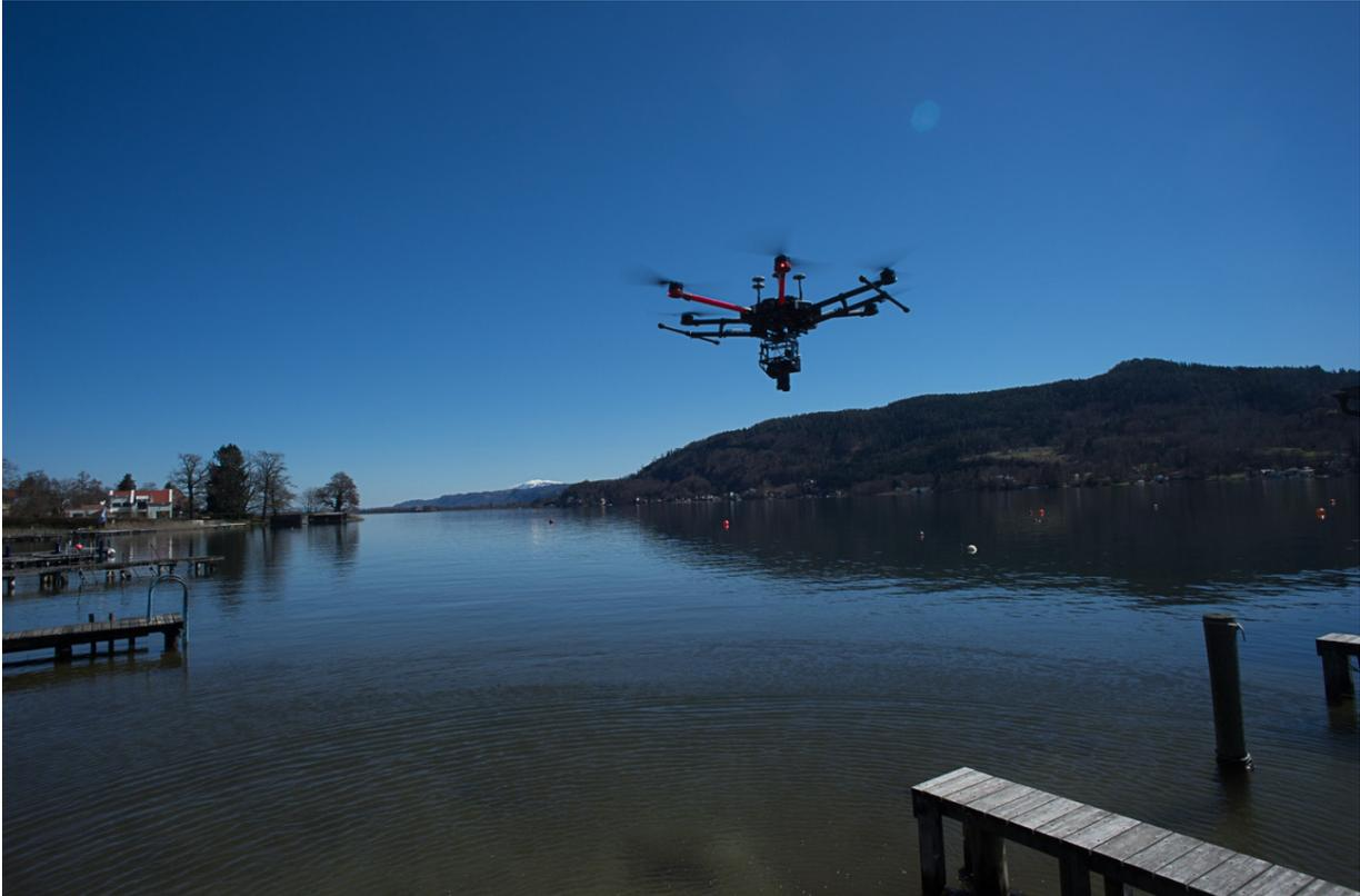
Abb. 1: UAS Multirotorsystem ViewCopter V6 H mit SONY A7R im Einsatz.
