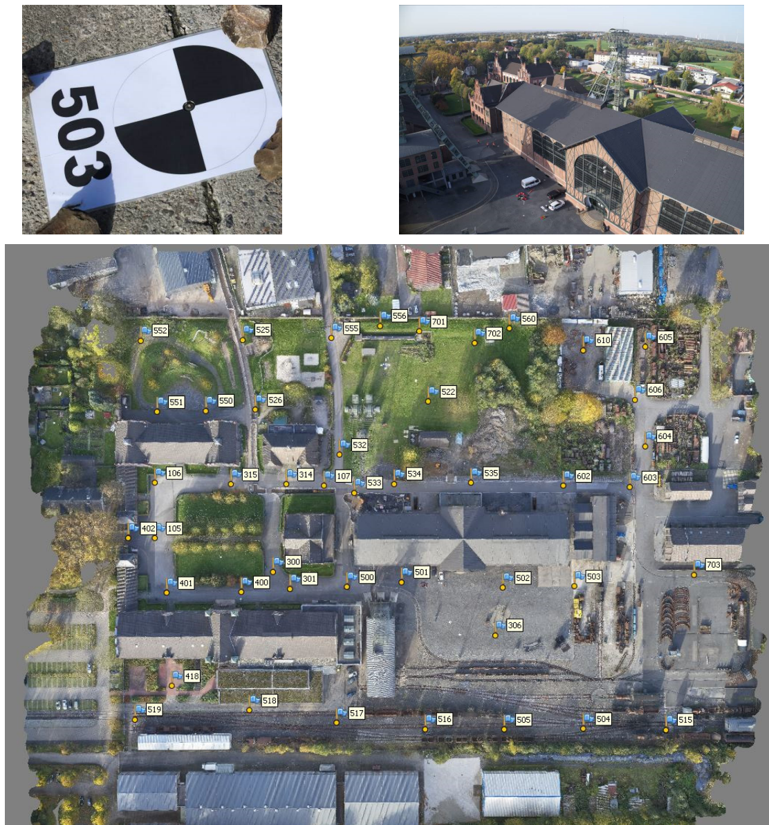
Abb. 2: UAV-Testfeld Zeche Zollern. Oben: Target zur Signalisierung der GCP sowie Blick auf das Areal Unten: Punktwolke mit signalisierten Bodenpasspunkten (UAV-Befliegung vom 16.10.2017)
